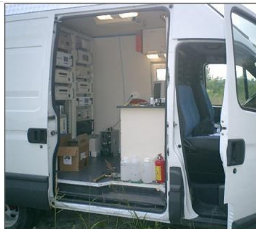
Figura 2-3: Monitoraggio qualità dell'aria mediante stazione mobile.
