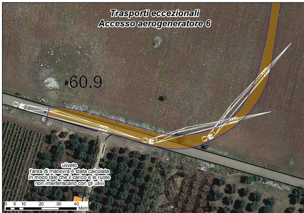
Accesso aerogeneratore 6 da SP 144 in retromarcia
