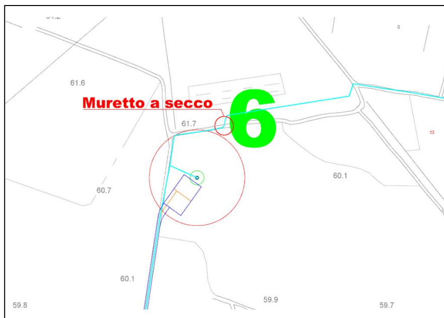
Posizione muretto a secco presso WTG 6 interferente con il solo cavidotto
