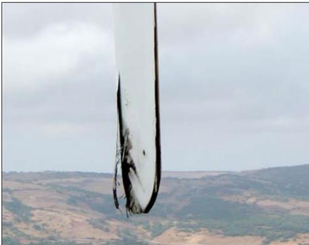
Estremità della pala danneggiata da fulminazione atmosferica
