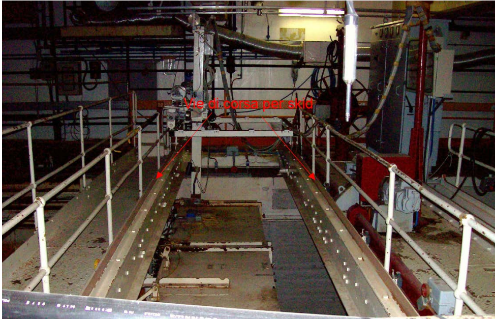
Figura 20: Vie di corsa per il posizionamento del sistema Skid sulla Gru Cesti.
