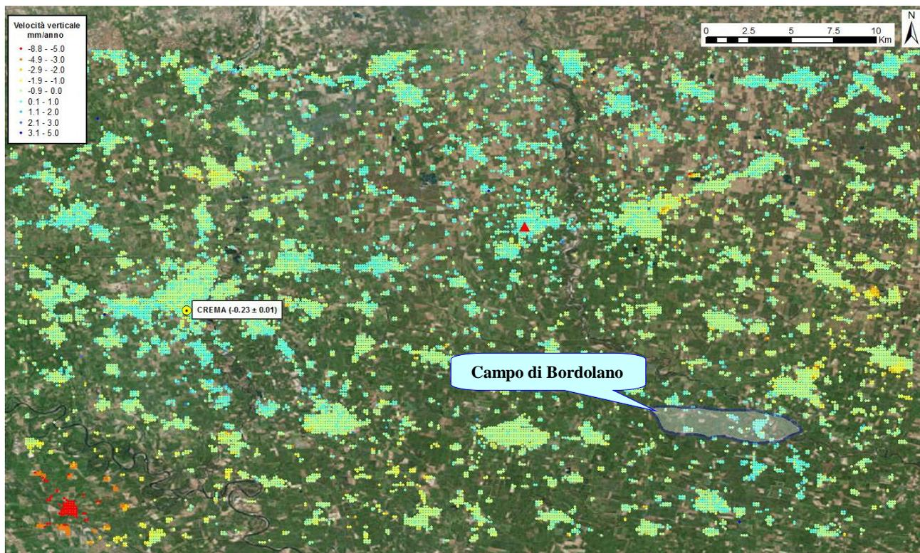
Fig. 7 – Dati dell'analisi Regional in scala di colori. I valori si riferiscono al solo vettore verticale risultato dalla scomposizione dei dati originali. Il triangolo rosso indica la posizione del punto di riferimento utilizzato per la scomposizione ed in giallo il GPS di Crema utilizzato per la calibrazione del dataset.
