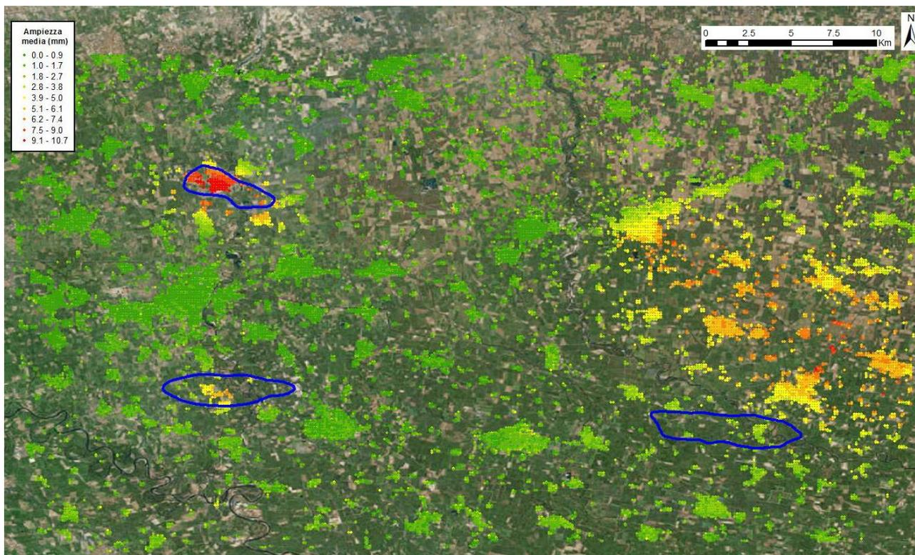
Fig. 12 – Dettaglio dei valori di ampiezza media della stagionalità per la componente verticale del rilievo Regional ed in blu le proiezioni in superficie dei giacimenti di Sergnano (a NW), Ripalta (a SW) e Bordolano (a SE).
