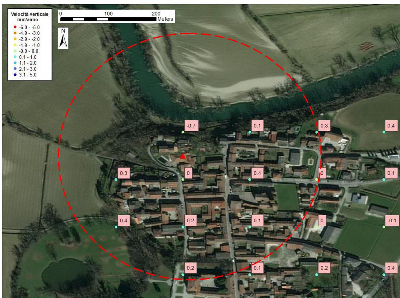
Fig. 17 – Visualizzazione del punto di riferimento utilizzato per la scomposizione Local (triangolo rosso) ed indicazione dei punti Regional più vicini con i rispettivi valori di velocità calibrati ed arrotondati ad una cifra decimale. L'area per la quale è stata calcolata la media delle velocità verticali è delimitata da un cerchio avente un raggio di circa 200 metri.
