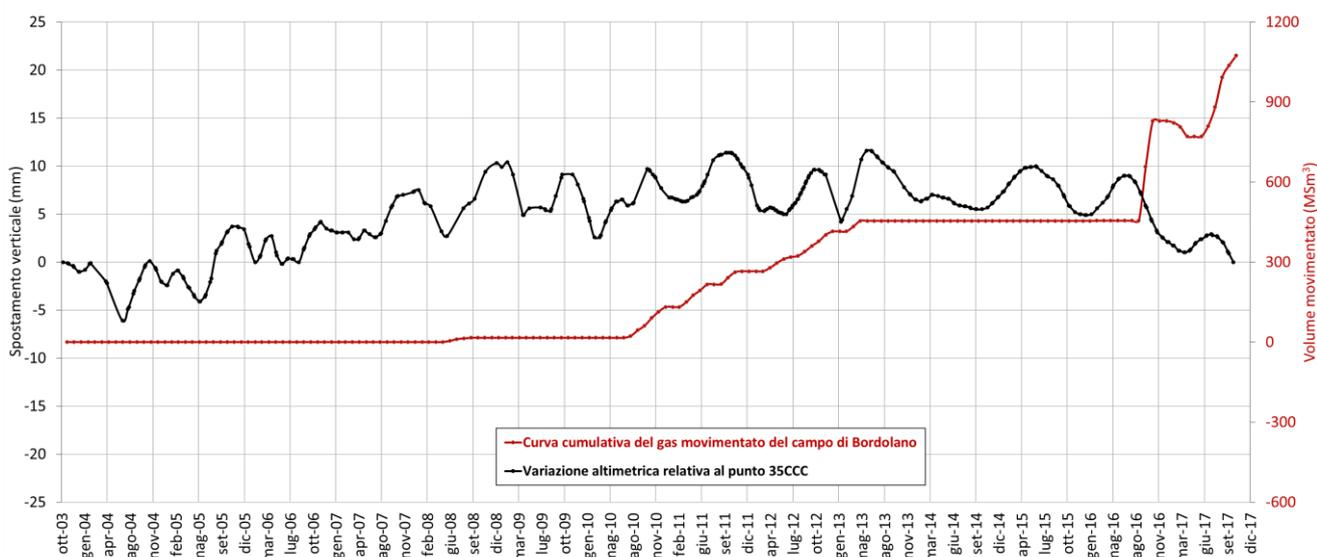
Fig. 27 – In alto, ubicazione del punto scomposto 35CCC con evidenza dei PS ascendenti e discendenti presenti nelle vicinanze e loro coerenza. In basso, confronto tra l'andamento temporale delle variazioni altimetriche del punto scomposto 35CCC e la curva del gas movimentato del giacimento di Bordolano.
