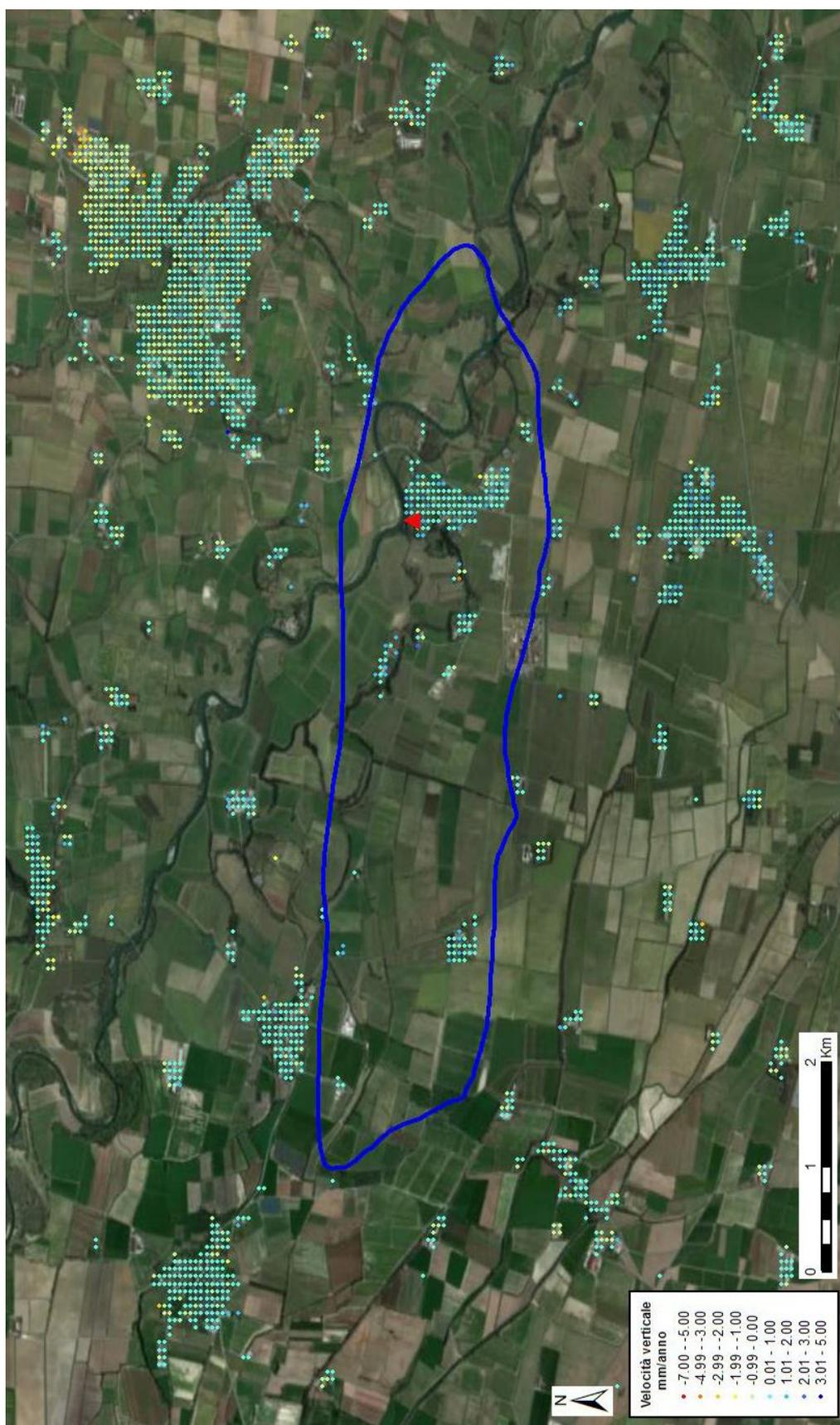
Fig. 15 – Visualizzazione in scala di colori delle velocità verticali dei punti scomposti dell’analisi Local, così come registrati dal satellite prima della calibrazione. Il triangolino rosso rappresenta il punto di riferimento.
