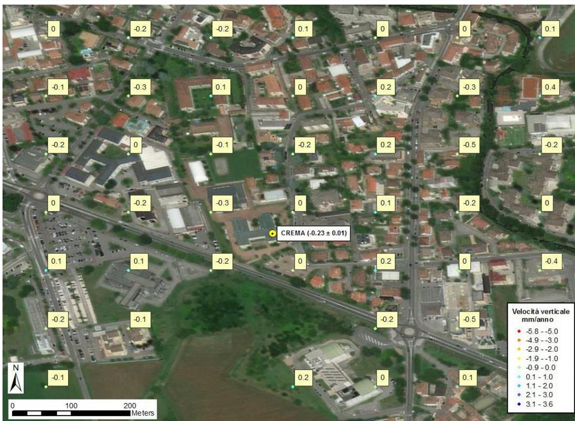
Fig. 8 – In giallo i punti dell’analisi Regional scomposti secondo il vettore verticale nell’immediato intorno del CGPS di Crema, con arrotondamento alla prima cifra decimale.
