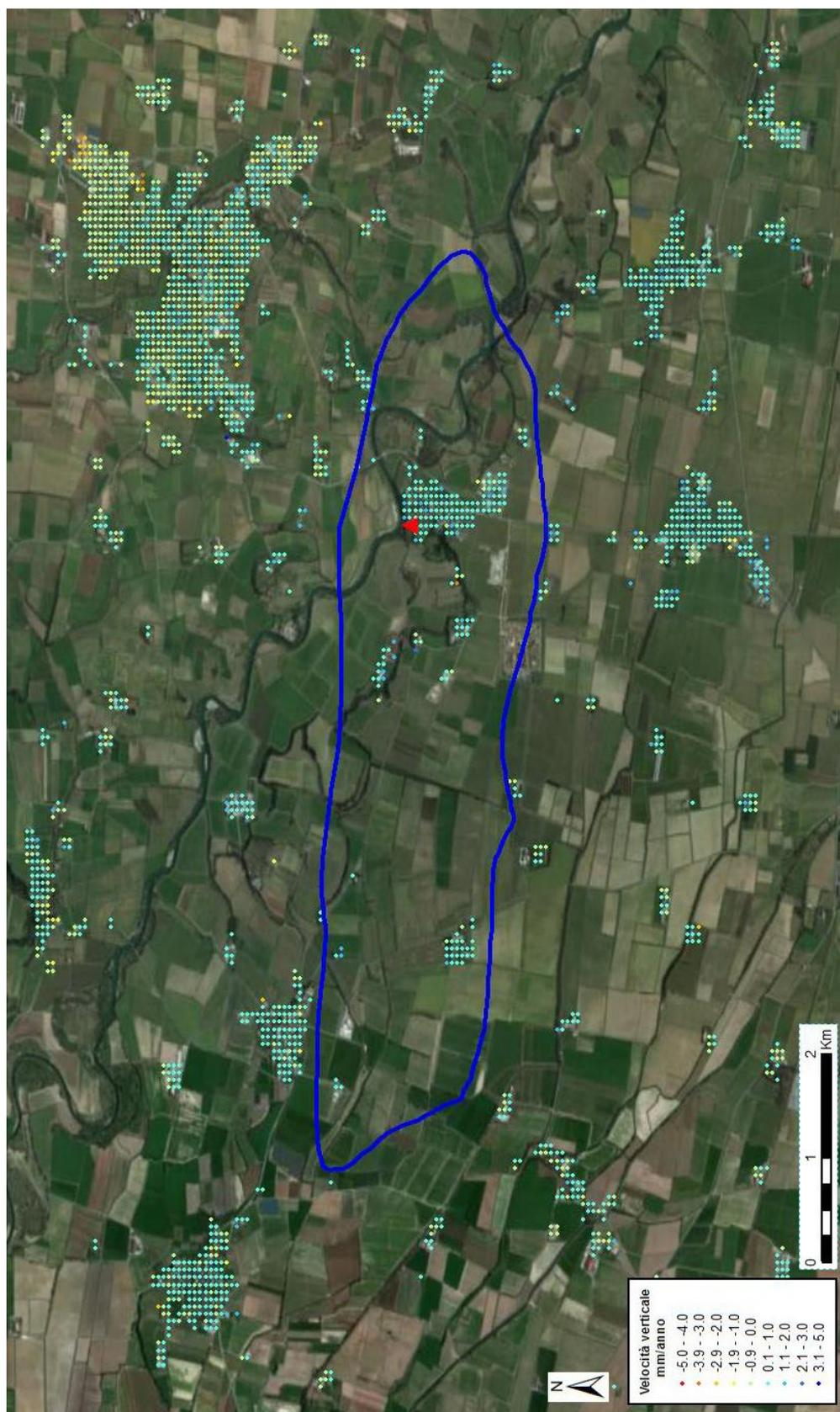
Fig. 19 – Visualizzazione in scala di colori delle velocità verticali dei punti scomposti dell’analisi Local dopo la variazione di  $-0.11$  mm/anno effettuata sull’intero dataset. Il triangolo rosso indica la posizione del punto di riferimento utilizzato per la scomposizione del vettore velocità.
