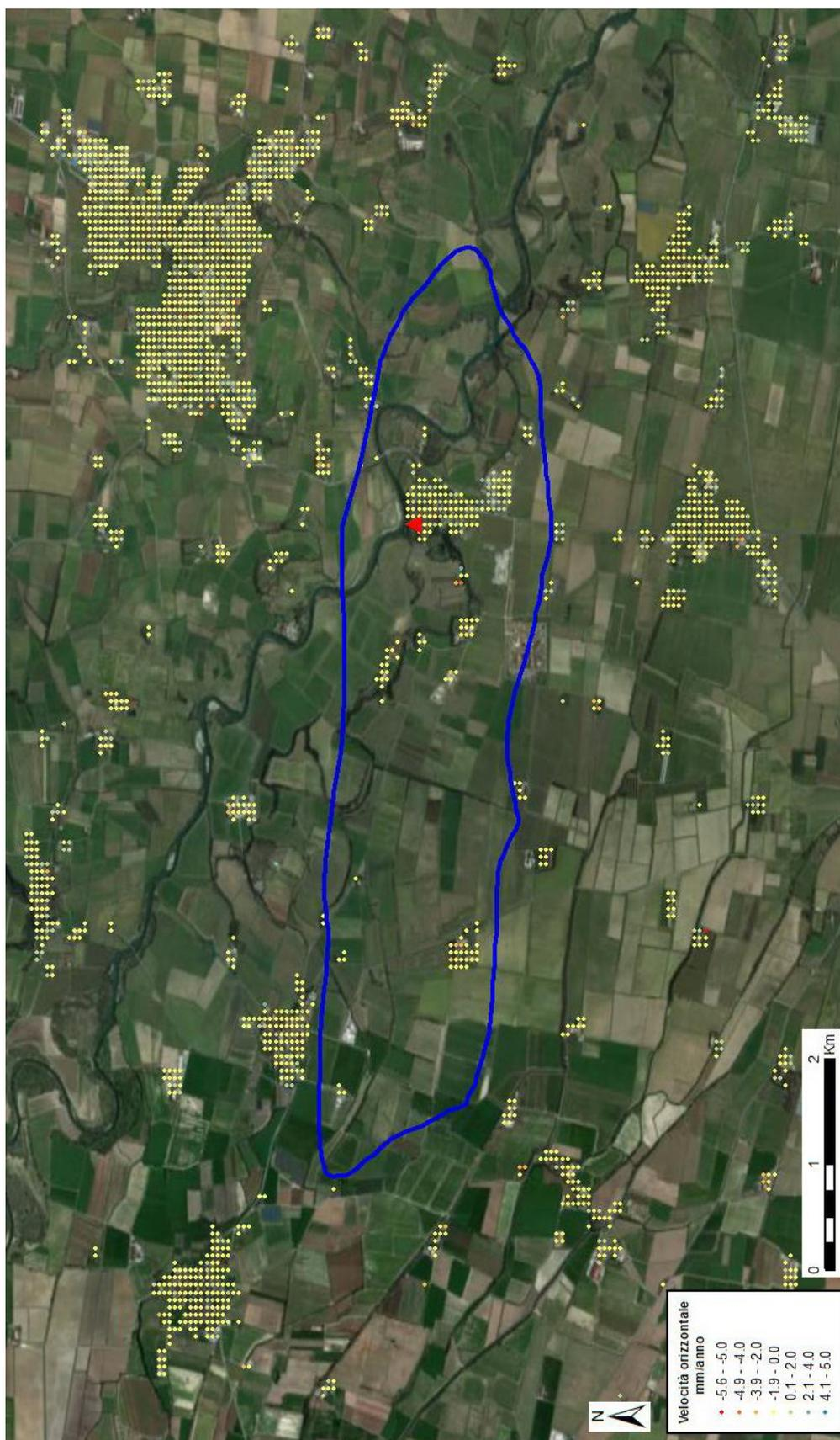
Fig. 16 – Visualizzazione in scala di colori delle velocità orizzontali dei punti scomposti dell'analisi Local. Il triangolino rosso rappresenta il punto di riferimento.
