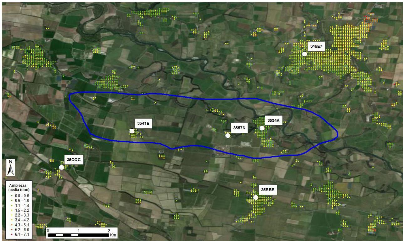
Fig. 22 – Valori medi di ampiezza della stagionalità calcolati per la componente verticale dei PS Local ed ubicazione dei 3 punti interni e dei 3 punti esterni alla proiezione in superficie del limite del giacimento.
