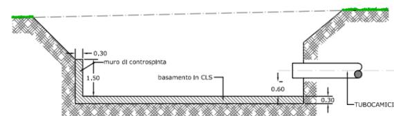
Particolare struttura di ancoraggio alla tubazione
