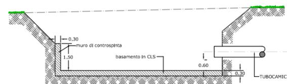
Particolare struttura di ancoraggio alla tubazione
