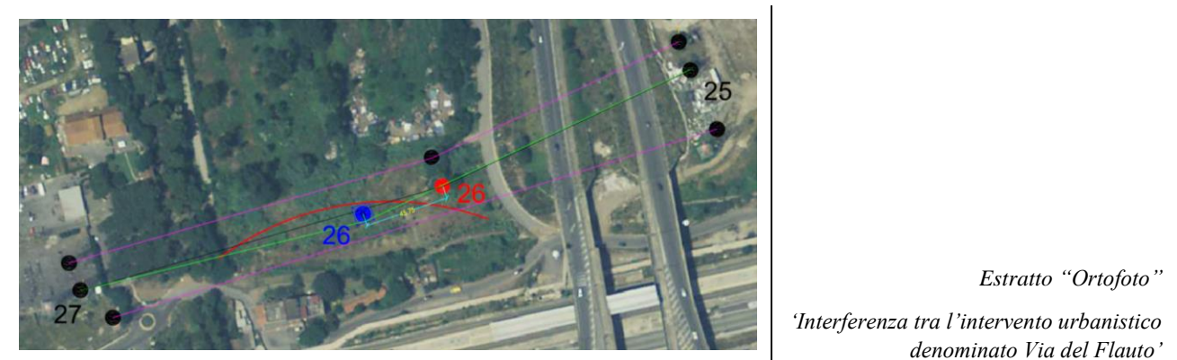
Fig. 1/2: In rosso - sostegni da demolire. In nero – linea esistente da demolire In verde - linea da progetto. In blu – sostegno da progetto.
