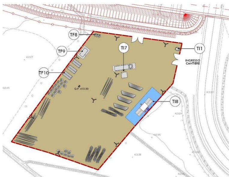
FIGURA 4-30 LAY-OUT FUNZIONALE DEL CANTIERE CO "D" (ESTRATTO DALL'ELABORATO T00CA01CANLF01A)
