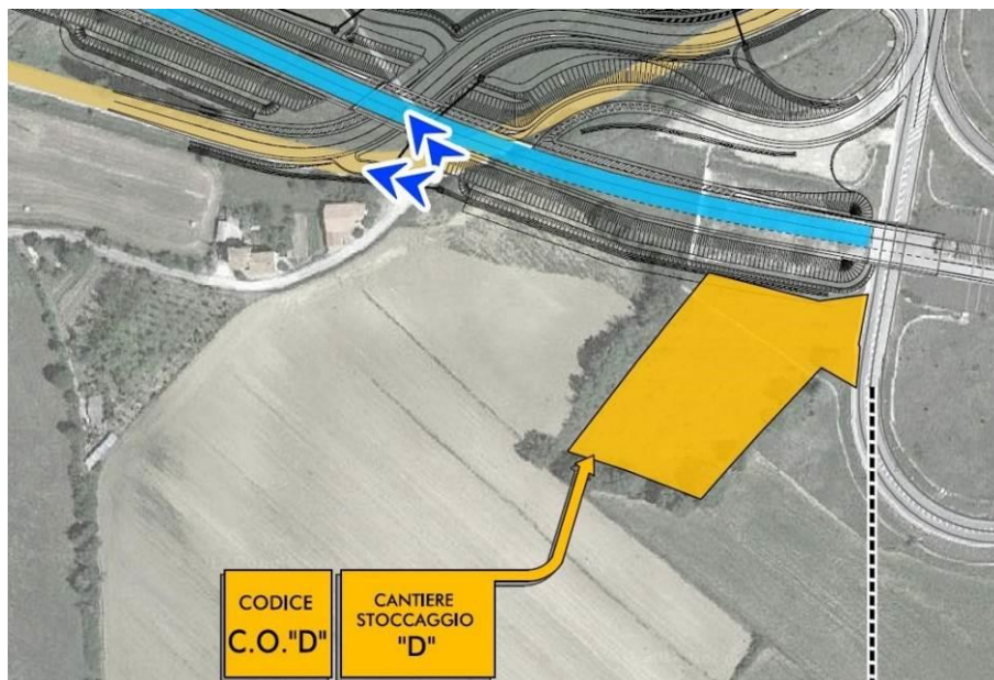
FIGURA 4-29 INQUADRAMENTO TERRITORIALE DELL'AREA DI CANTIERE "D" CON INDICAZIONE DEL SISTEMA DI ACCESSO (ESTRATTO DALL'ELABORATO T00CA01CANPL02A)
