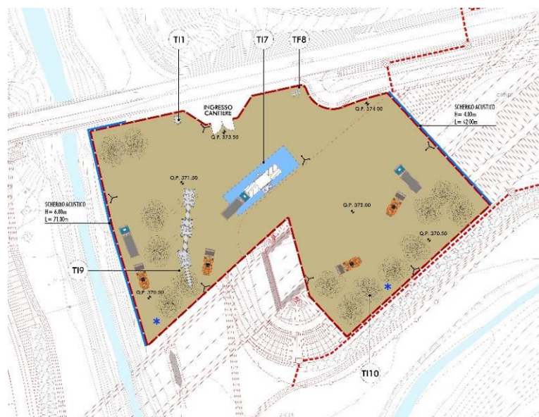
FIGURA 4-20 LAY-OUT FUNZIONALE DEL CANTIERE "B" DURANTE LA PRIMA CONFIGURAZIONE DI CANTIERE (ESTRATTO DALL'ELAB. T00CA01CANLF08A)
