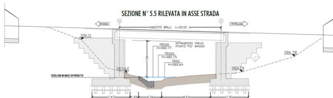
Figura 3-25 – Viadotto Fosso Brillì nella configurazione di Progetto Esecutivo, calato sulla sezione idraulica ricavata da rilievo celerimetrico
