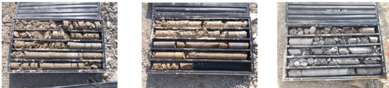
**Figura 1 Carotaggi del sondaggio SMO-1 – profondità 5-10 m, 10-15 m e 20-25 m**
