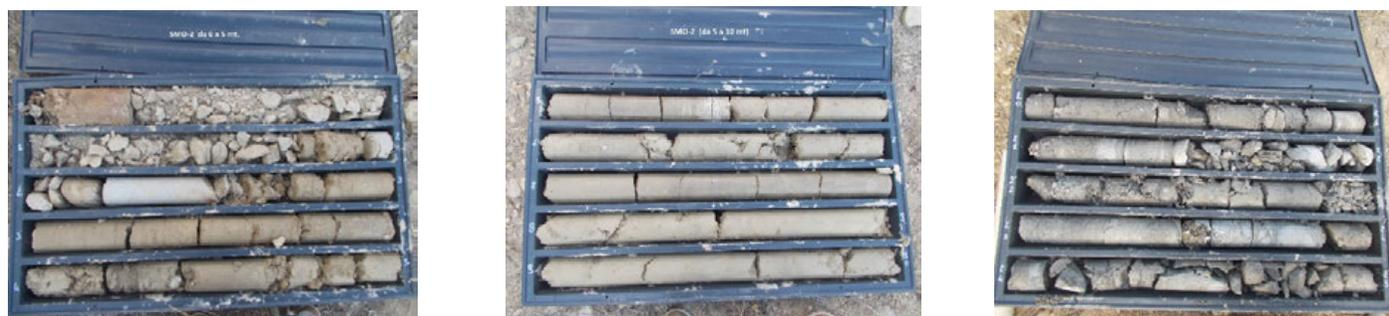
**Figura 2 Carotaggi del sondaggio SMO-2 – profondità 5-10 m, 10-15 m e 20-25 m**
