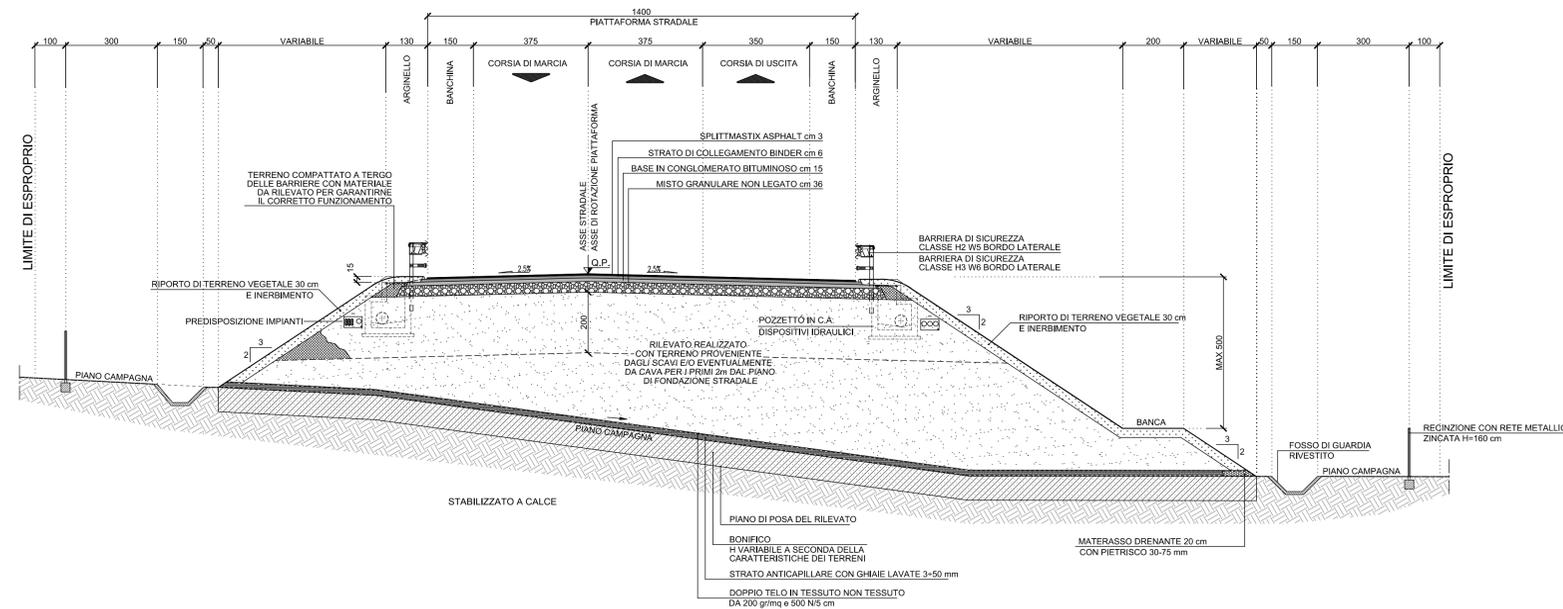
SEZIONE TIPO IN CORRISPONDENZA DELLE CORSE DI USCITA
