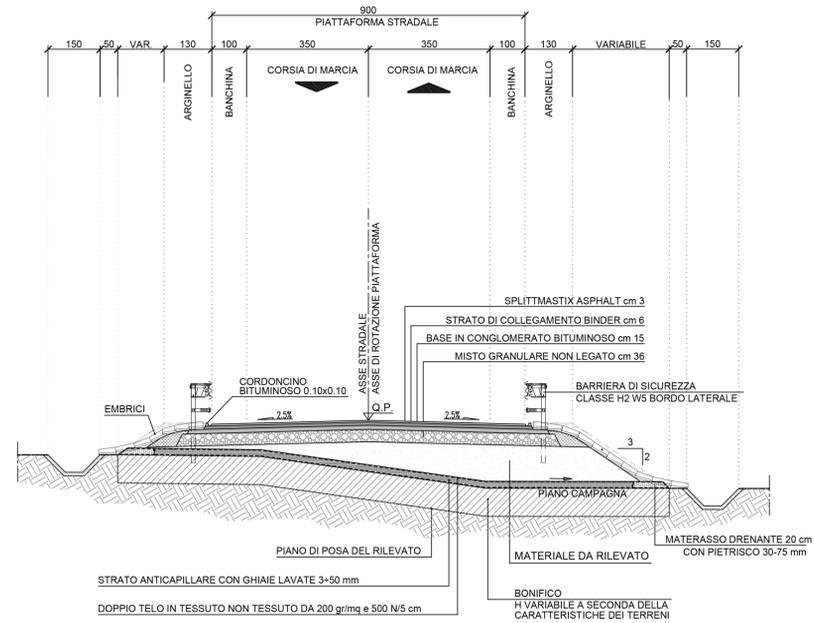
SEZIONE TIPO IN RILEVATO
