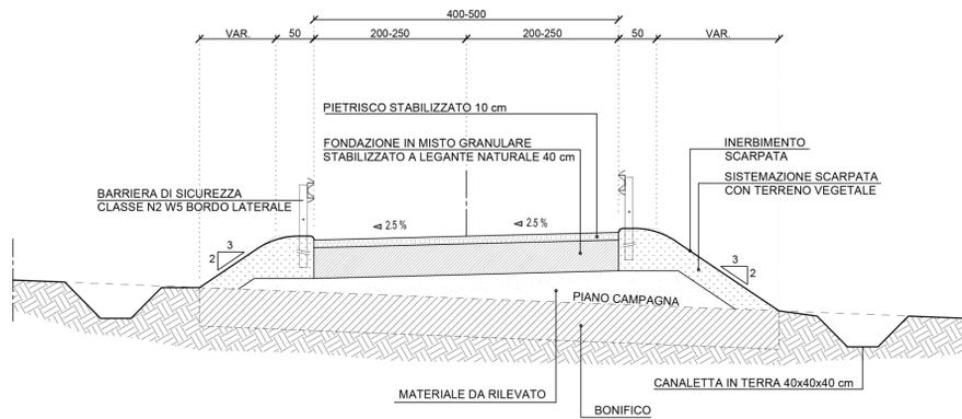
SEZIONE TIPO IN RILEVATO
