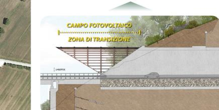
A. AUMENTO DELLA SOSTENIBILITÀ AMBIENTALE energia elettrica. Utilizzo dell'energia elettrica prodotta in loco per i consumi legati agli impianti in galleria e riduzione dei livelli di rumore caratteristici delle aree di imbocco delle
