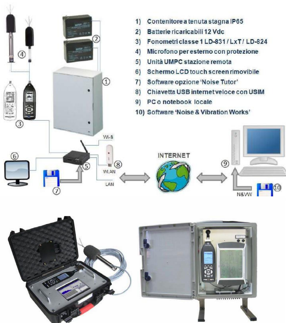
FIGURA 8-3 COMPONENTI SISTEMI DI MONITORAGGIO
