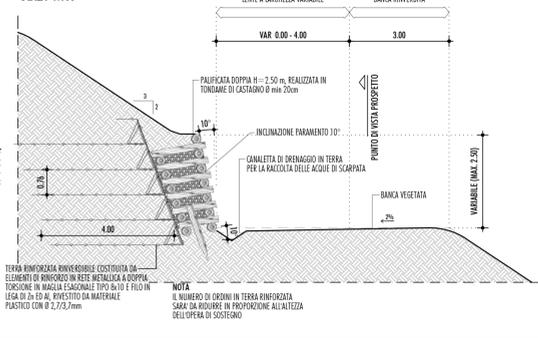
**PROSPETTO DELLA BANCA CON ALLARGAMENTO
