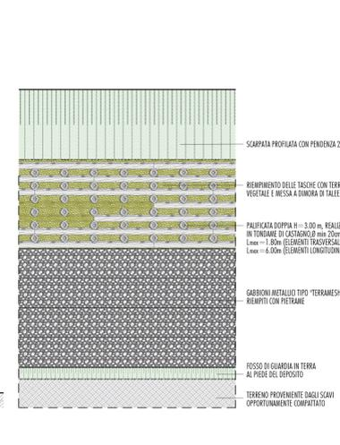
**SEZIONE TIPO DELLA BANCA CON ALLARGAMENTO
