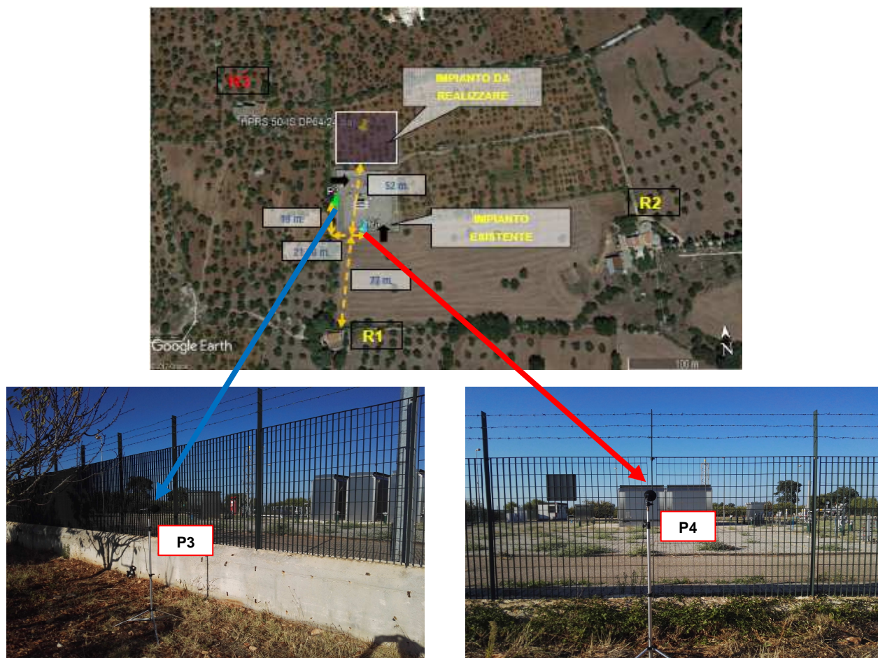
Fig. 7.6 - Inquadramento planimetrico e foto dei microfoni Punti P3 e P4.
