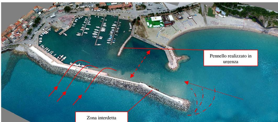
Figura n. 17 - Vista generale con evidenza delle criticità
