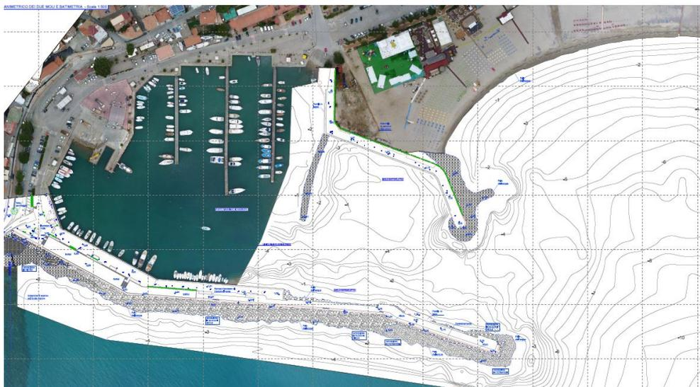
Figura n. 12 - Rilievo dell'area portuale - Batimetria su ortofoto.
