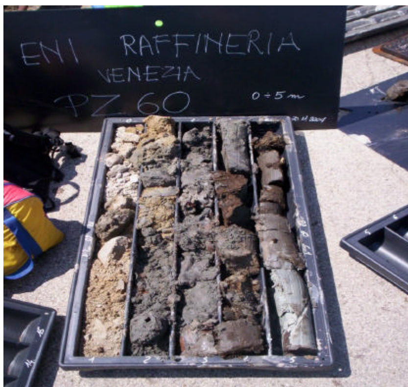
Sondaggio PZ60 da 0 m a 5 m.
