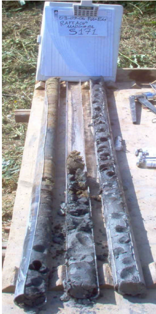
Sondaggio S171 da 0 m a 3,6 m.
