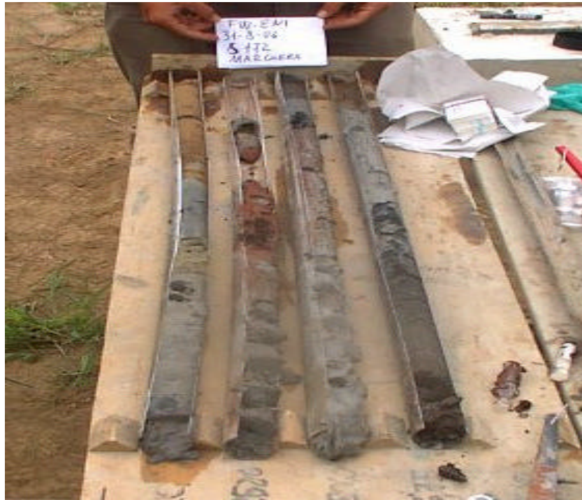
Sondaggio S172 da 0 m a 4,8 m.
