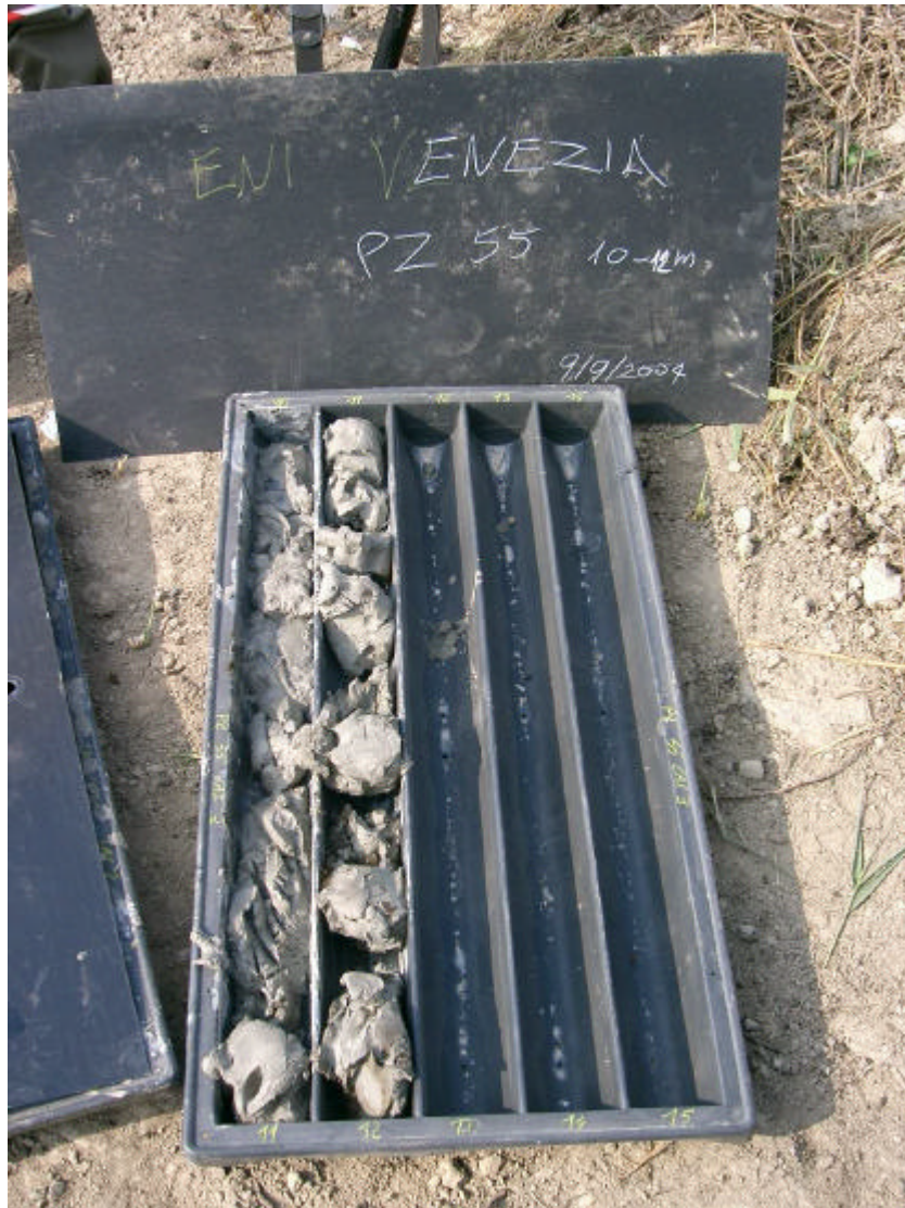
Sondaggio PZ55 da 10 m a 12 m.
