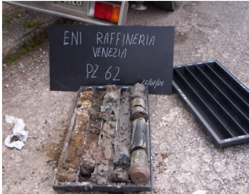
Sondaggio PZ62 da 0 m a 5 m.
