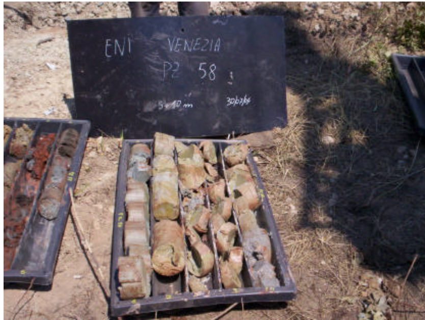
Sondaggio PZ58 da 5 m a 10 m.
