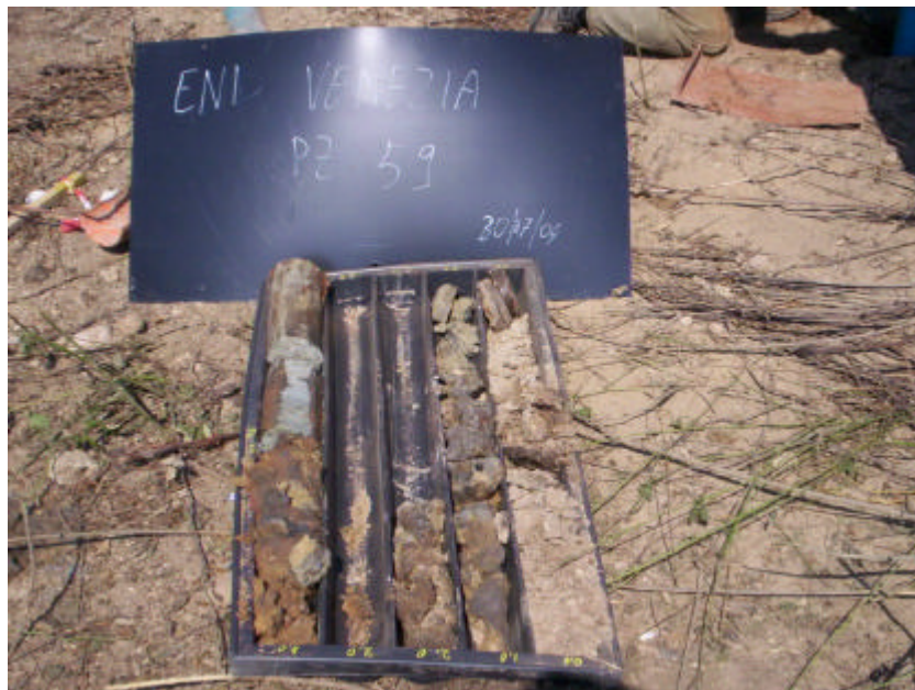
Sondaggio PZ59 da 0 m a 5 m.
