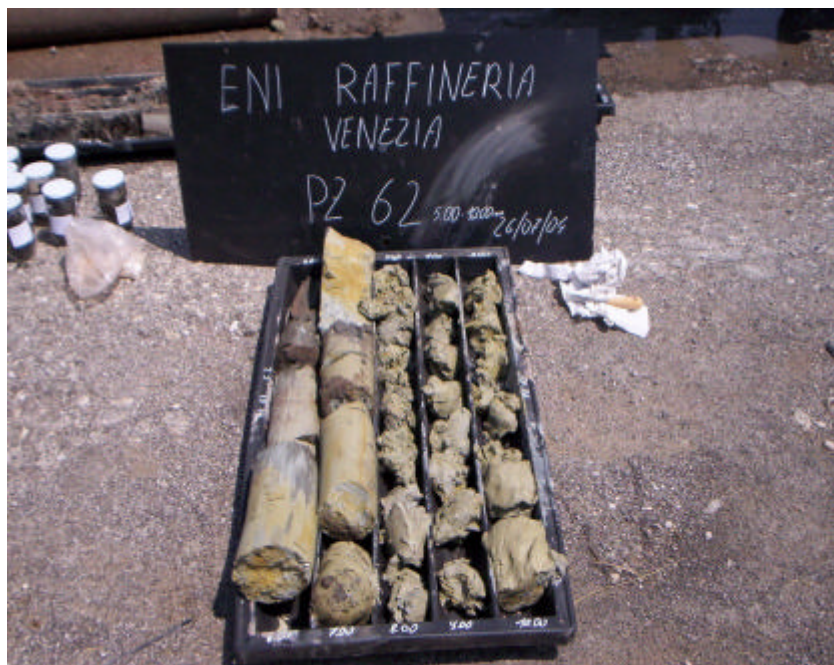
Sondaggio PZ62 da 5 m a 10 m.
