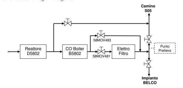
I fumi prodotti dal reattore possono essere inviati, mediante bypass, direttamente al camino. Un analogo bypass è presente in uscita al CO BOILER, mentre il punto di prelievo e di misura del sistema monitoraggio emissioni è posto all'uscita dell'unità elettrofiltro perché le condizioni di esercizio del camino, all'apertura dei bypass del CO Boiler, non permettono l'installazione di strumentazione a camino
