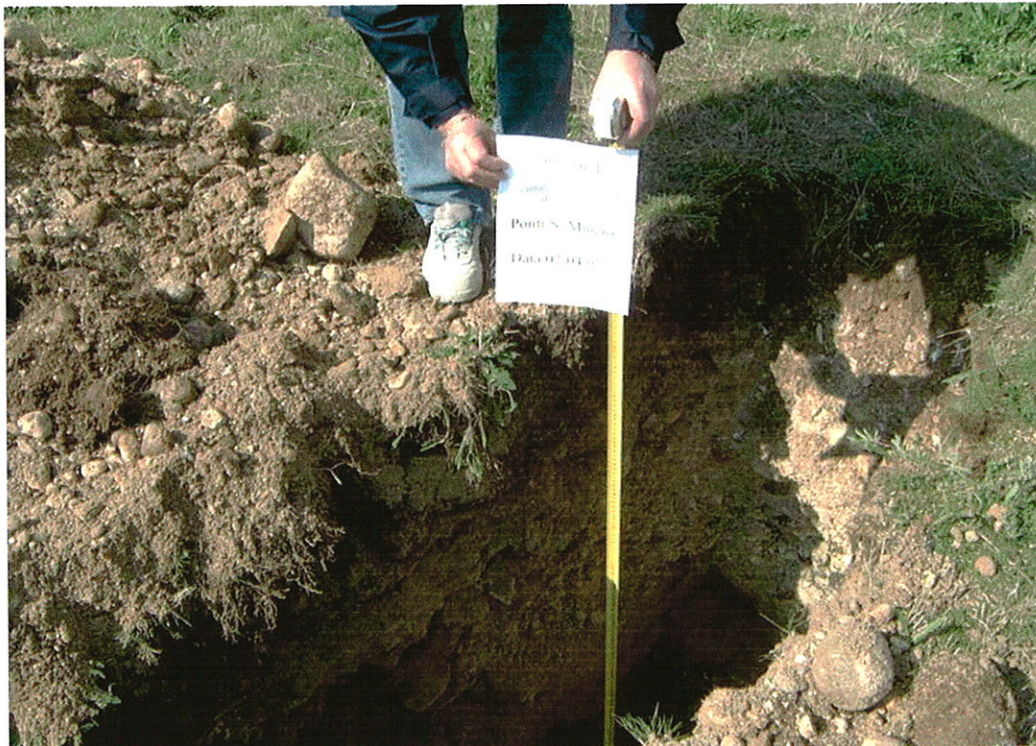
Sond. 1 prelevato alla profondità di 2.5 m dal p.c. - Deposito ghiaioso-ciottoloso
