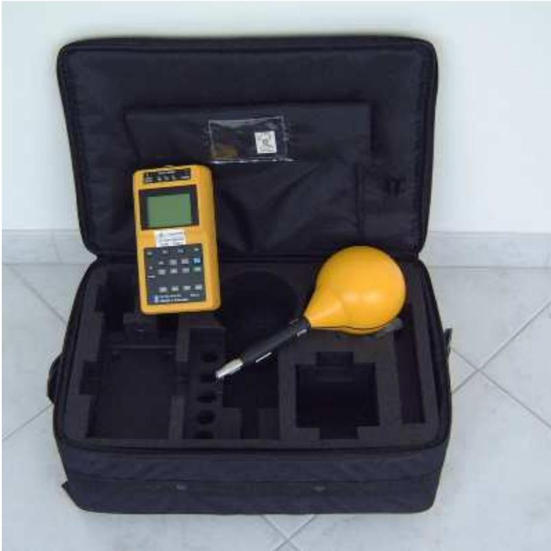
Fig. 4.1 - Strumento per le misure in bassa frequenza (unità principale – a sinistra) e sensore di induzione magnetica (a destra)
