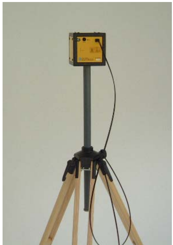
Fig. 2 - Sensore di campo elettrico in bassa frequenza su supporto in materiale isolante e fibra ottica per il collegamento all'unità principale
