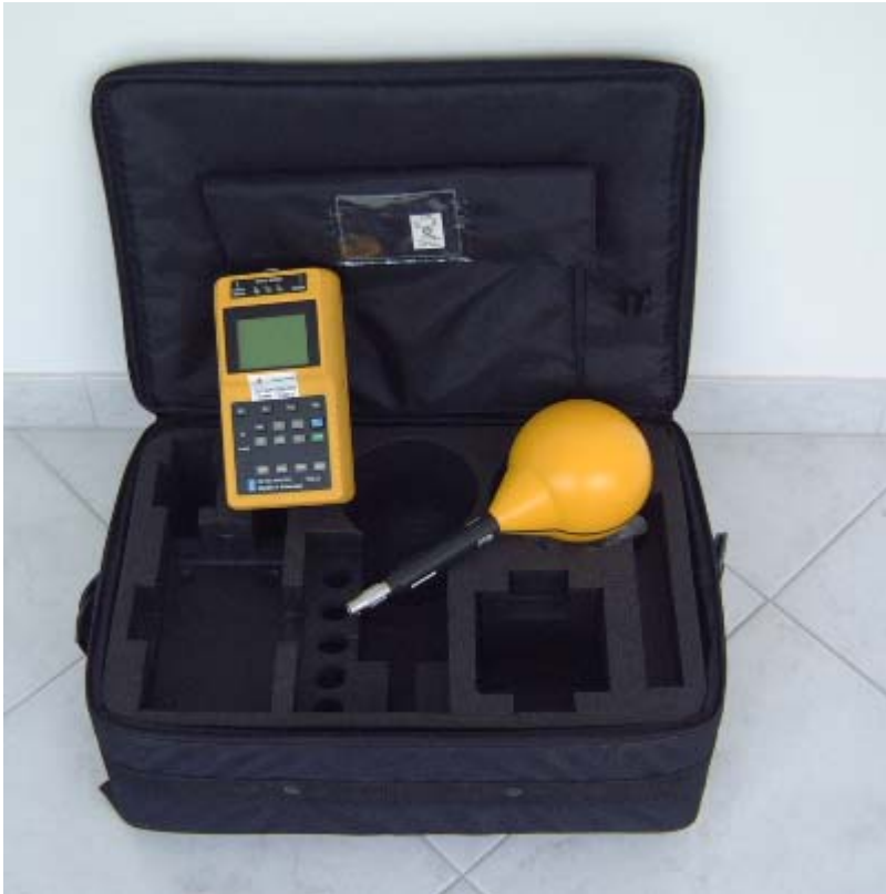
Fig. 1 - Strumento per le misure in bassa frequenza (unità principale – a sinistra) e sensore di induzione magnetica (a destra)
