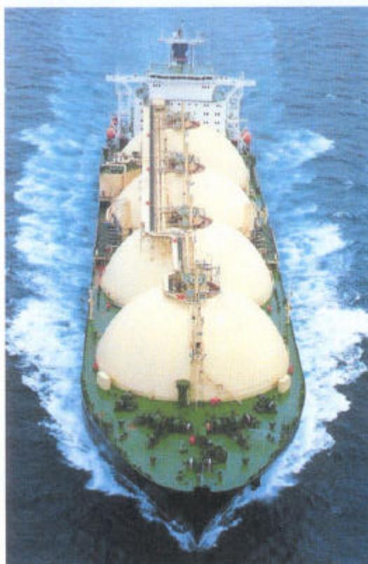
Fig. 8.2 - Esempio di nave metaniera con serbatoi sferici (tecnologia Moss-Rosenberg).
