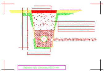
Pozzetto d'ispezione - tubazione 800 mm -
