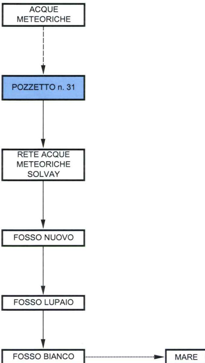
**SCHEMA A BLOCCHI SCARICHI IMPIANTI - SOTTOSTAZIONE GASOLIO**
