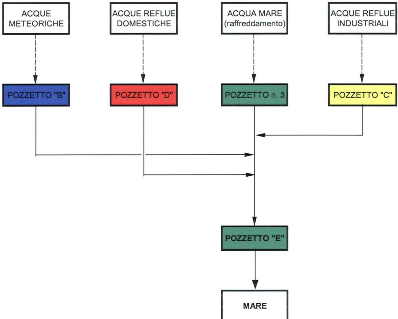
**SCHEMA A BLOCCHI SCARICHI IMPIANTI - SOTTOSTAZIONE METANO**
