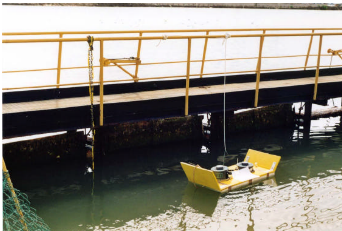
Fig. AII-14 Andamento temporale della temperatura registrata nella stazione canale artificiale Candiano – opera di presa della centrale e fotografia del punto di installazione dello strumento
