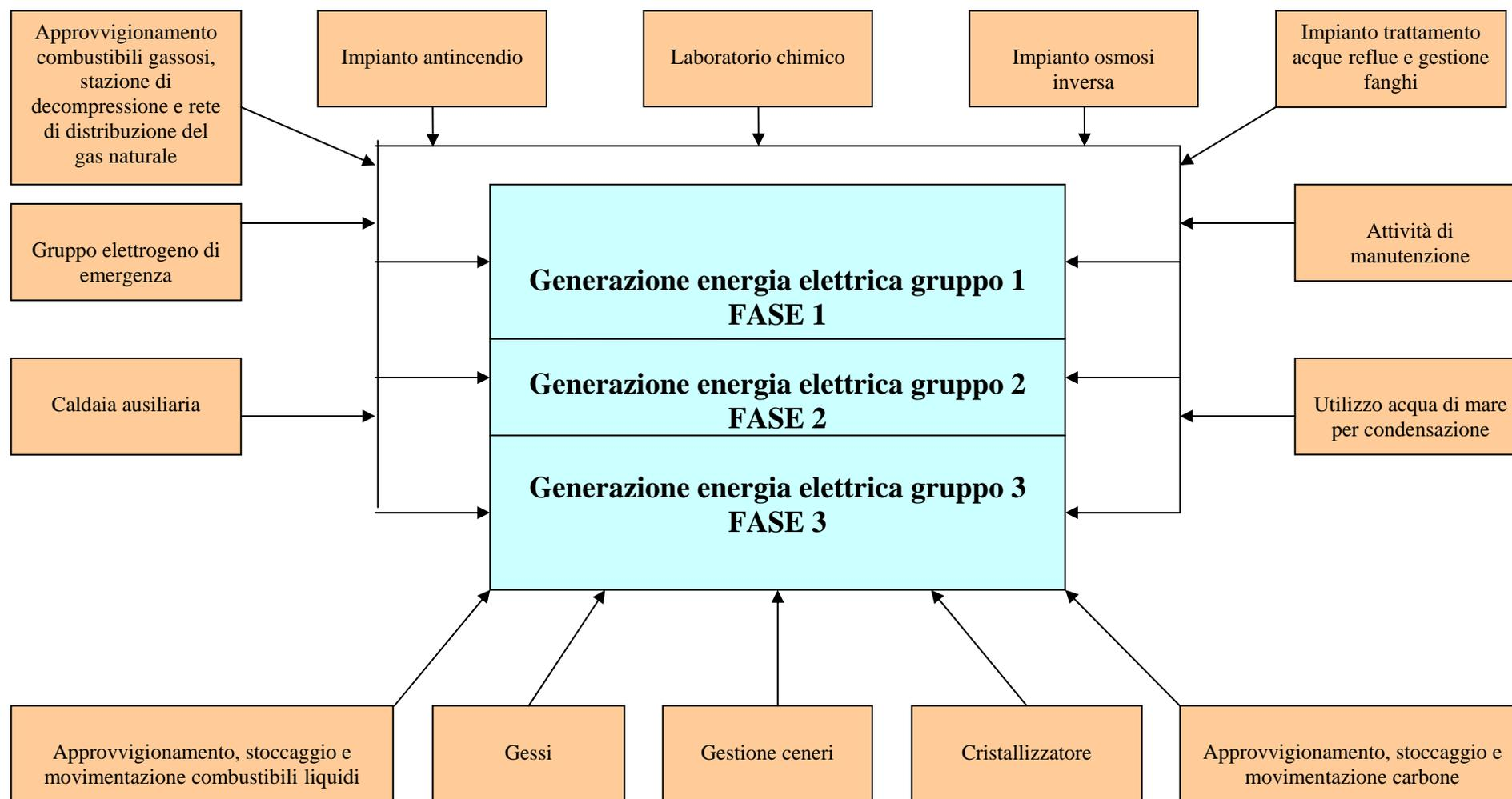
**A.25 – Schema a blocchi delle fasi e delle attività tecnicamente connesse (attività ausiliarie)**
