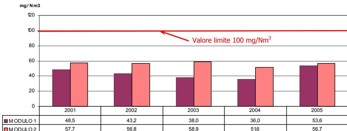
**Grafico 8 – Concentrazioni medie annue di CO rilevate nei fumi emessi (dati in mg/Nm<sup>3</sup>)**
