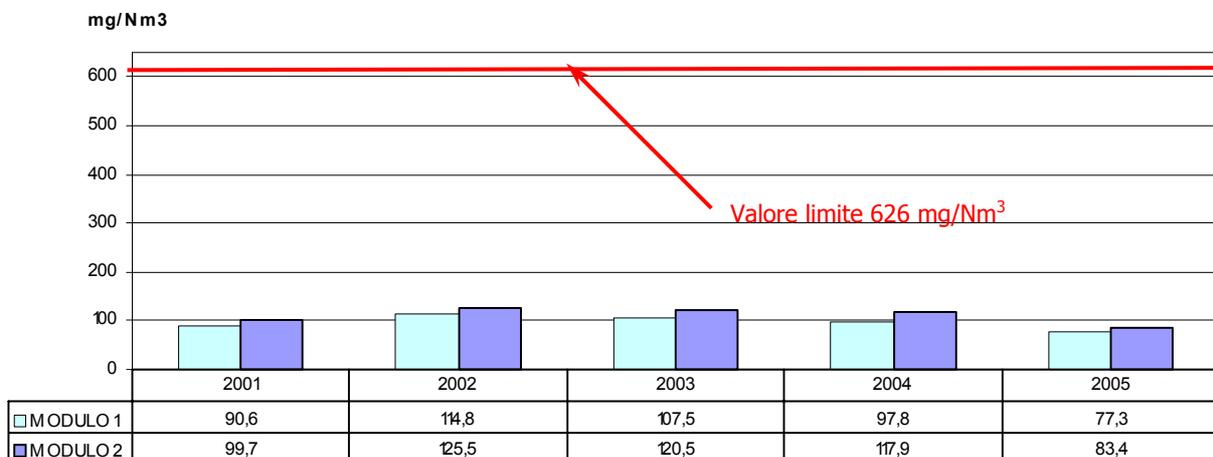
**Grafico 7 – Concentrazioni medie annue di NO<sub>x</sub> rilevate nei fumi emessi (dati in mg/Nm<sup>3</sup>)**
