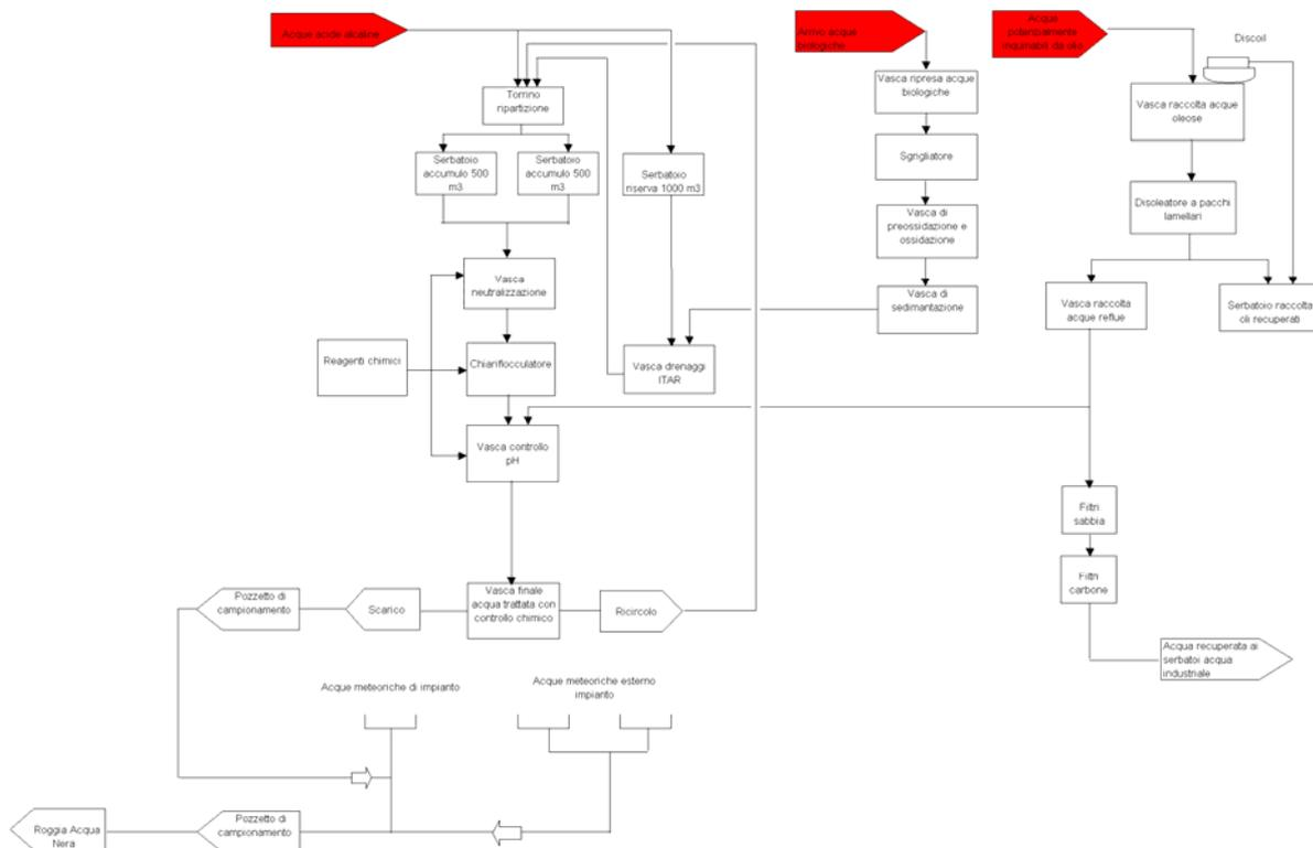
**Figura 11 – Schema semplificato impianto di trattamento acque reflue (ITAR)**
