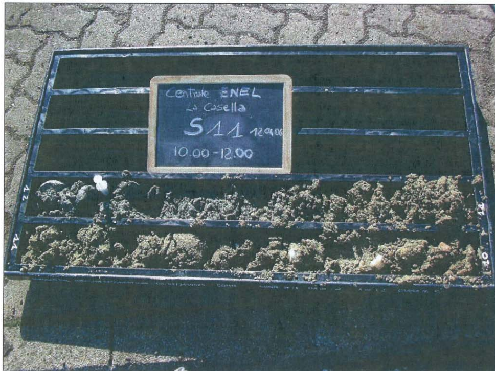
Sondaggio S11 (10,00 – 12,00 m)
