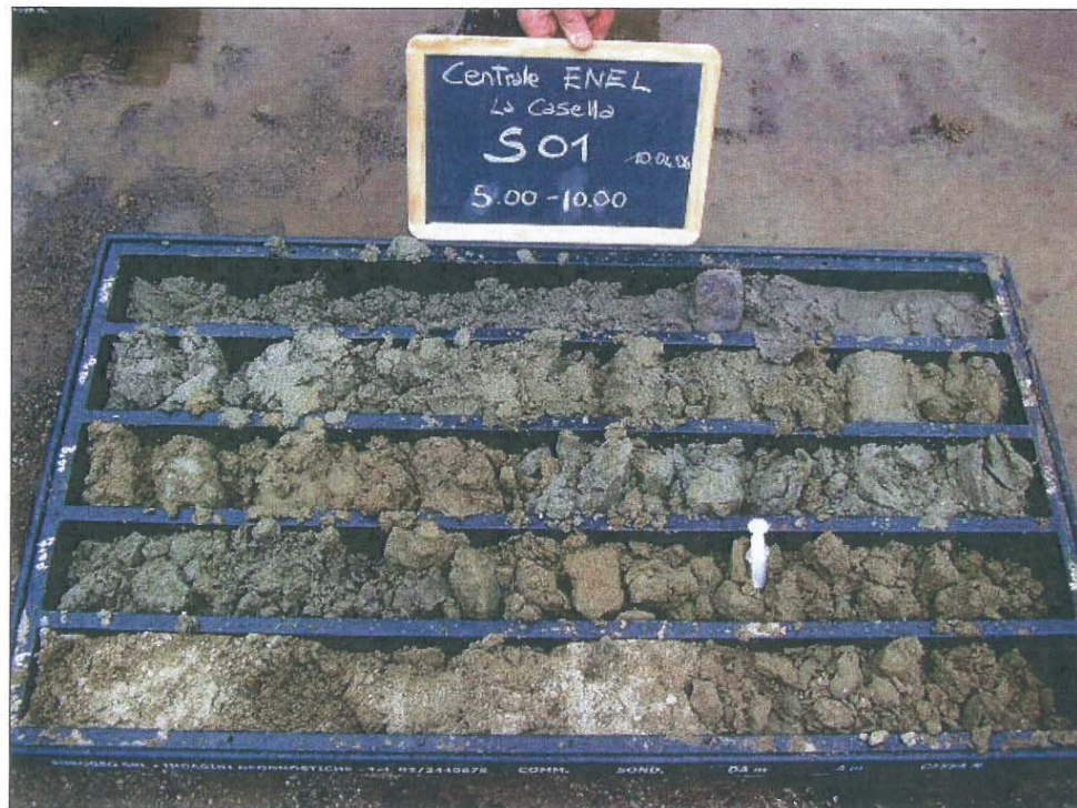
Sondaggio S01 (5,00 – 10,00 m)
