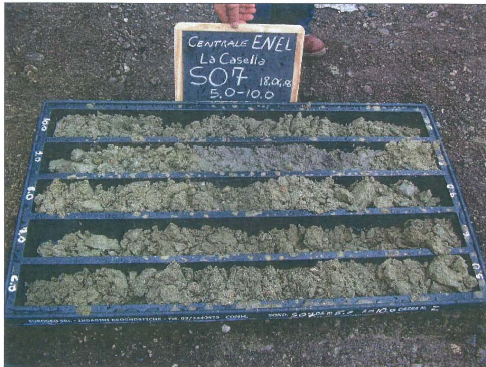
Sondaggio S07 (5,00 – 10,00 m)
