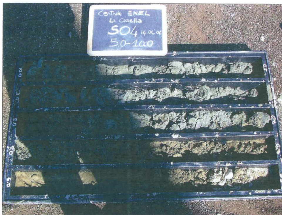
Sondaggio S04 (5,00 – 10,00 m)
