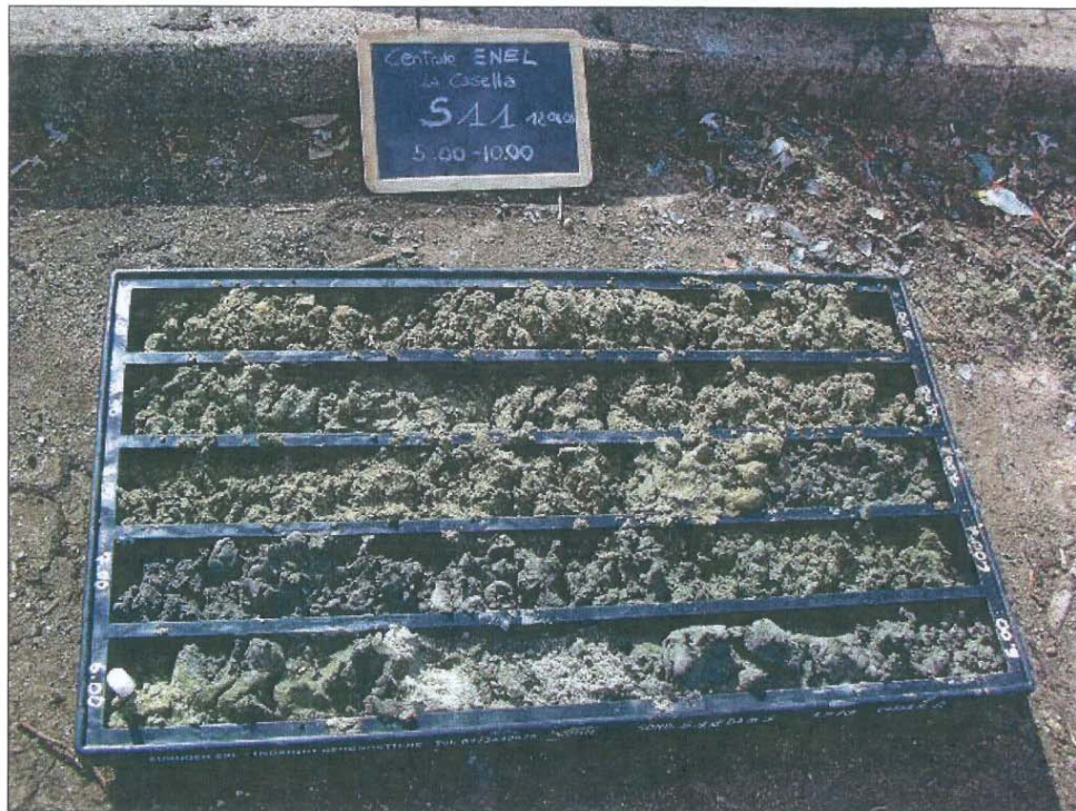
Sondaggio S11 (5,00 – 10,00 m)
