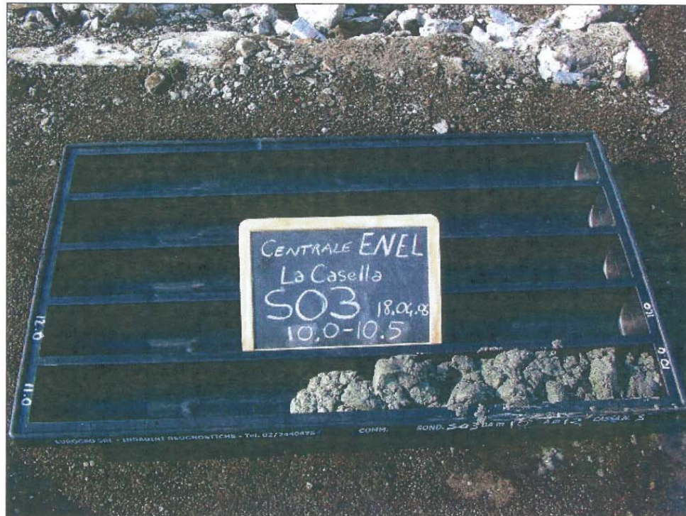
Sondaggio S03 (10,00 – 10,50 m)
