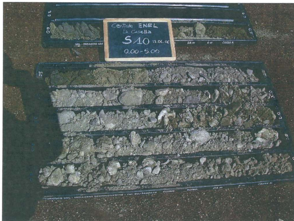
Sondaggio S10 (0,00 – 5,00 m)
