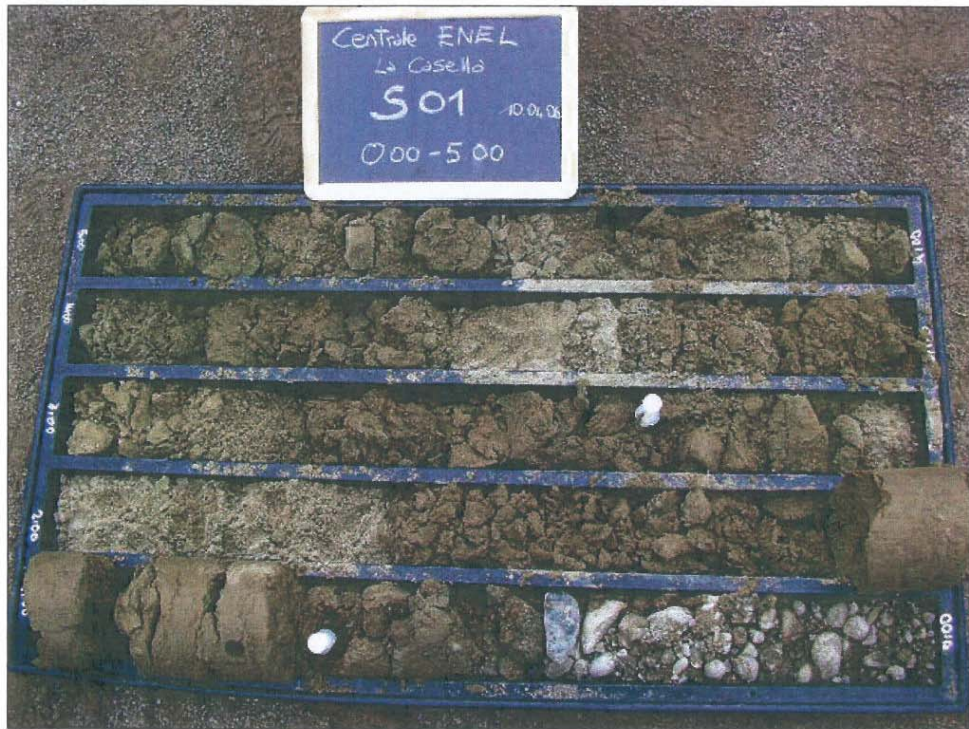
Sondaggio S01 (0,00 – 5,00 m)
