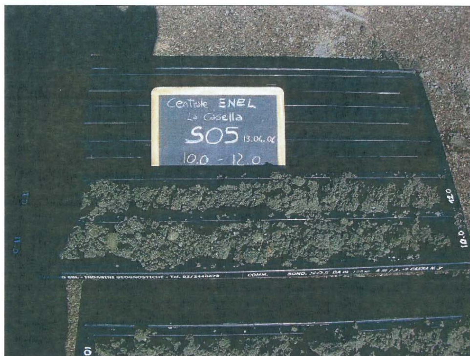
Sondaggio S05 (10,00 – 12,00 m)
