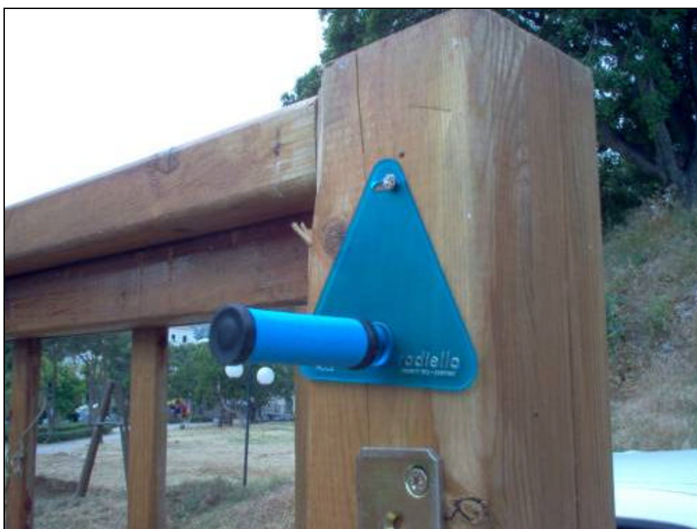
Figura 8 Campionatore diffusivo "Radiello"
