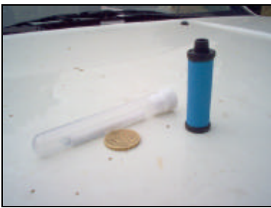
Figura 1 Elementi costituenti il campionatore diffusivo Radiello : a sinistra cartuccia assorbente, a destra corpo assorbente
