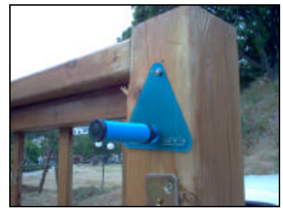
Figura 3 Montaggio completo ed esposizione del campionatore diffusivo Radiello
