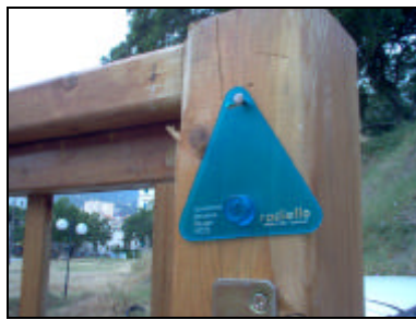
Figura2 Supporto triangolare con filettatura per l'alloggiamento del corpo diffusivo.
