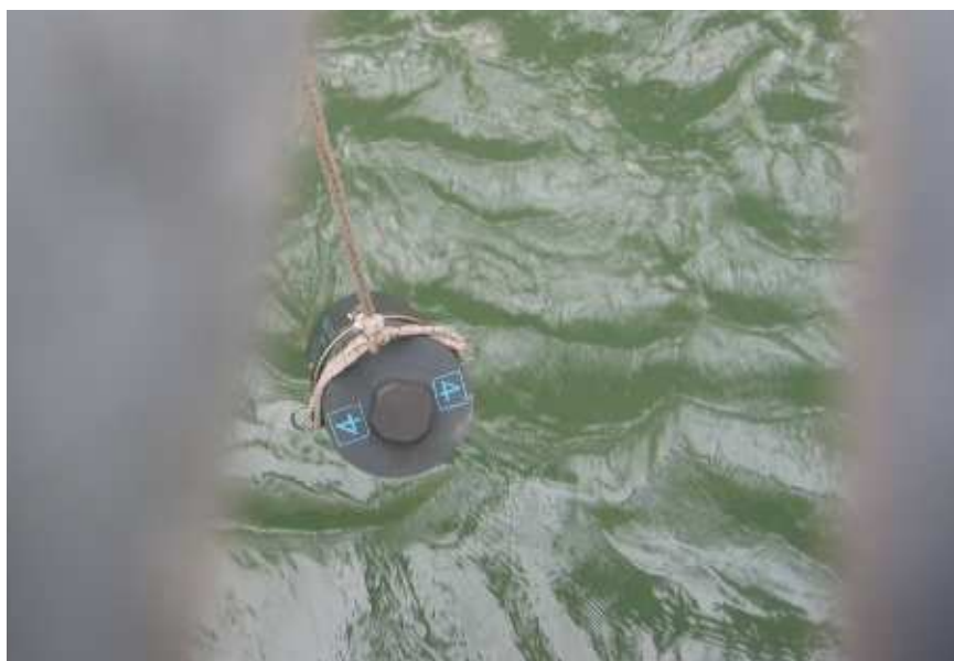
Fig.4 Installazione del termografo nell'opera di scarico della centrale
