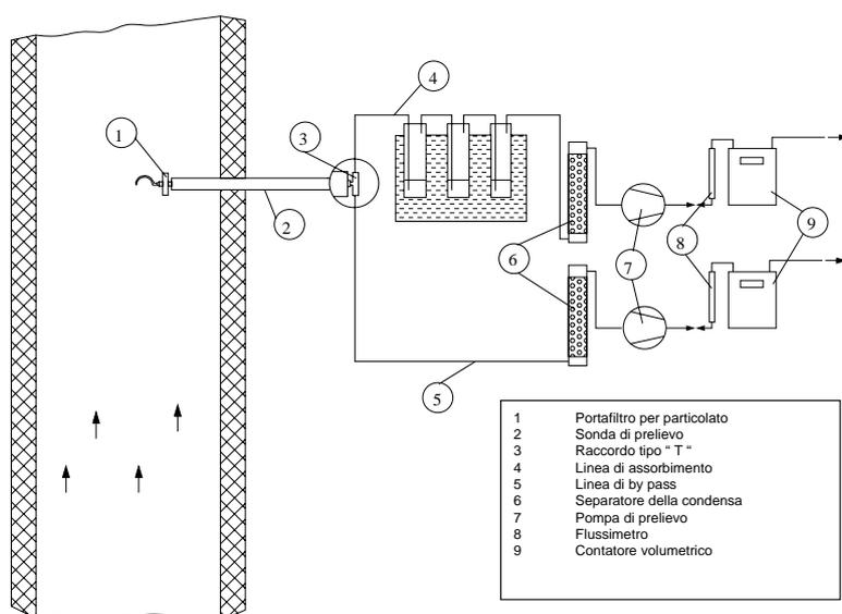
determinazione della concentrazione di Hg viene aggiunta una trappola finale come da norma prEN 13211 (draft, 1998).
