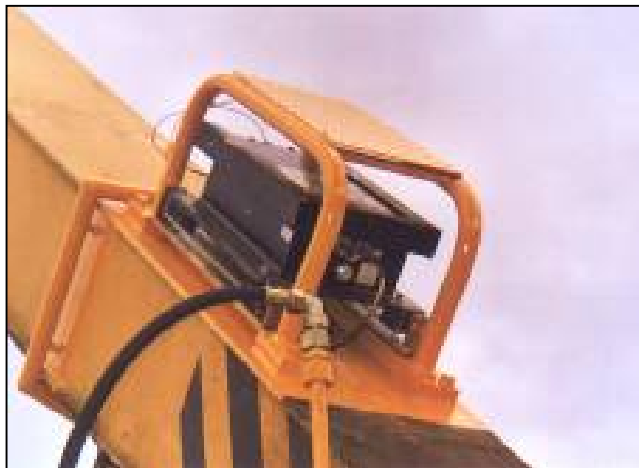
Foto n. 16 – Sistema di rilevazione radioattività -
