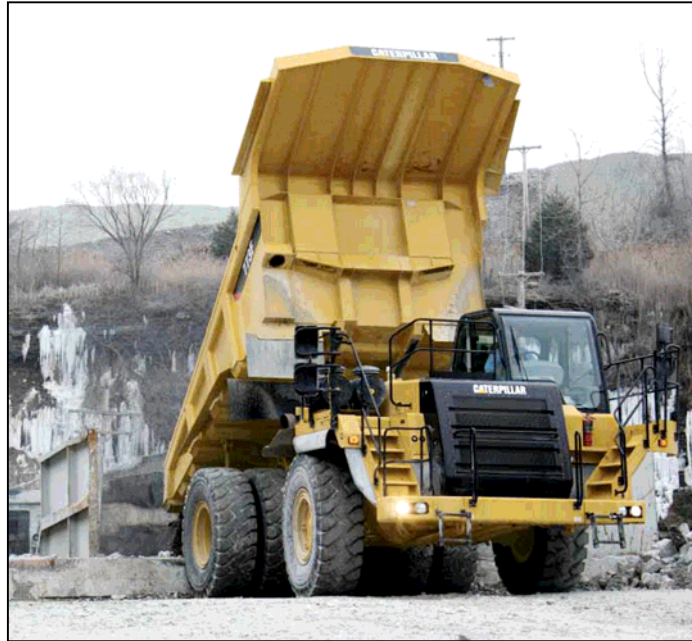
Foto n. 5 – Dumper per la movimentazione dei materiali –
