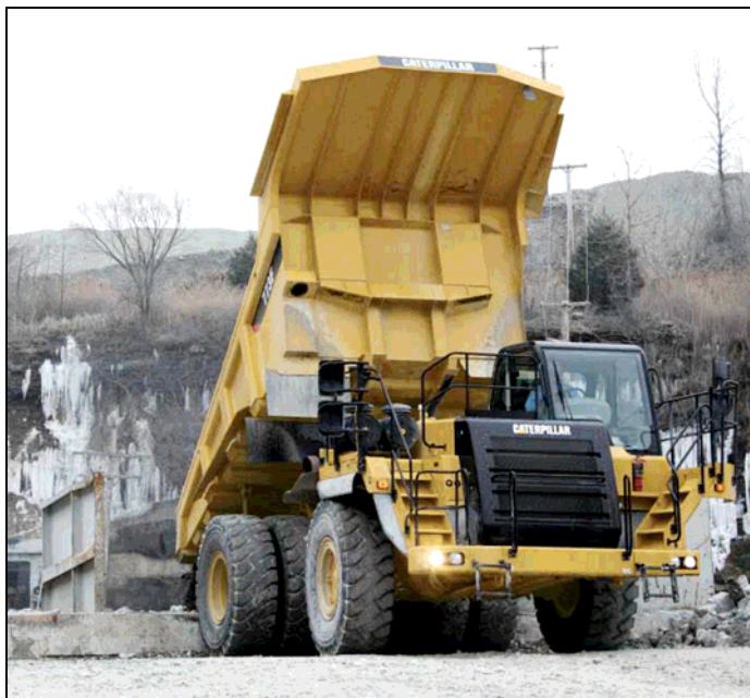
Foto n. 5 – Dumper per la movimentazione dei materiali –
