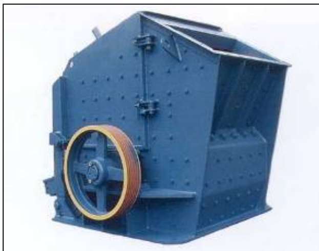
Figura n. 13 – Esempio di frantoio -
