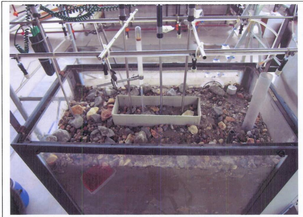
**Figura 30 - Vista dall'alto dell'impianto dotato di sistema di irrorazione acqua e della vaschetta di contenimento.**
