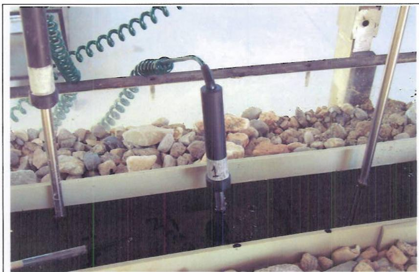
**Figura 25 - Formazione dello strato di battente di OCD all'interno della vaschetta di contenimento**
