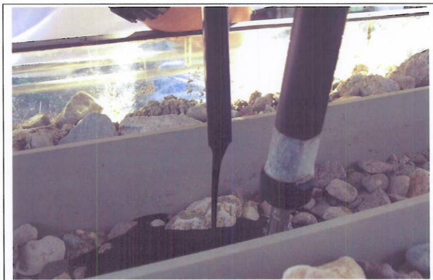
**Figura 24 - Fase iniziale dello sversamento all'interno della vaschetta di contenimento.**
