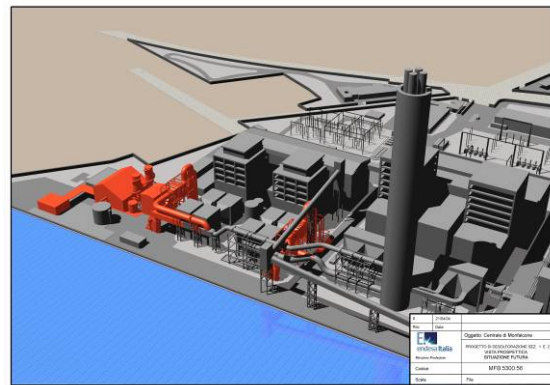
Figura 6 - Vista dell'impianto dopo l'installazione dei desolfinatori
