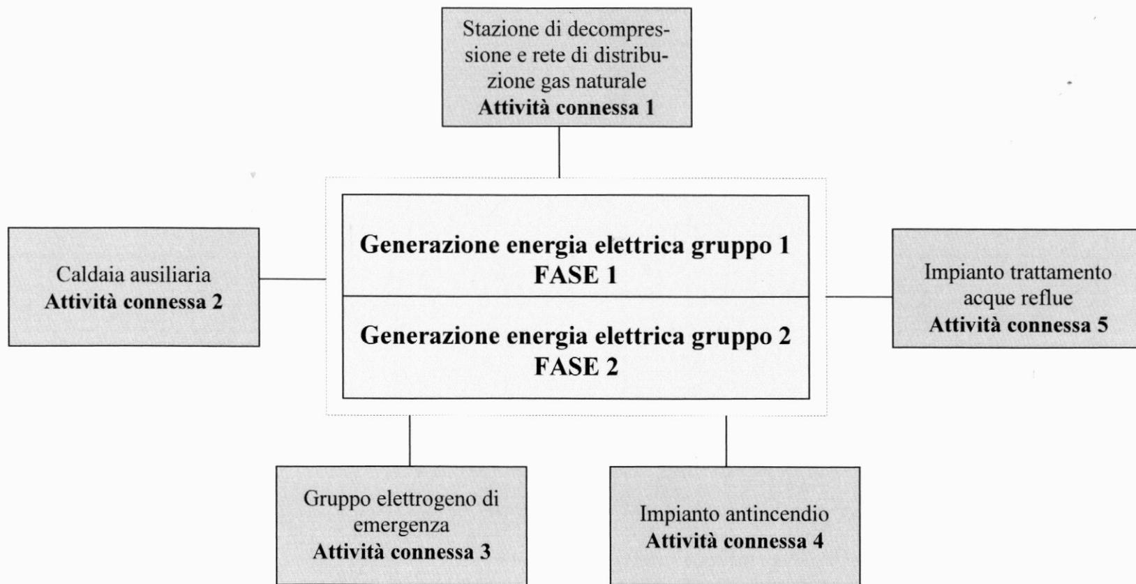
**A.25 Schema a blocchi delle fasi e delle attività tecnicamente connesse (attività ausiliarie) dell'impianto di Alessandria**
