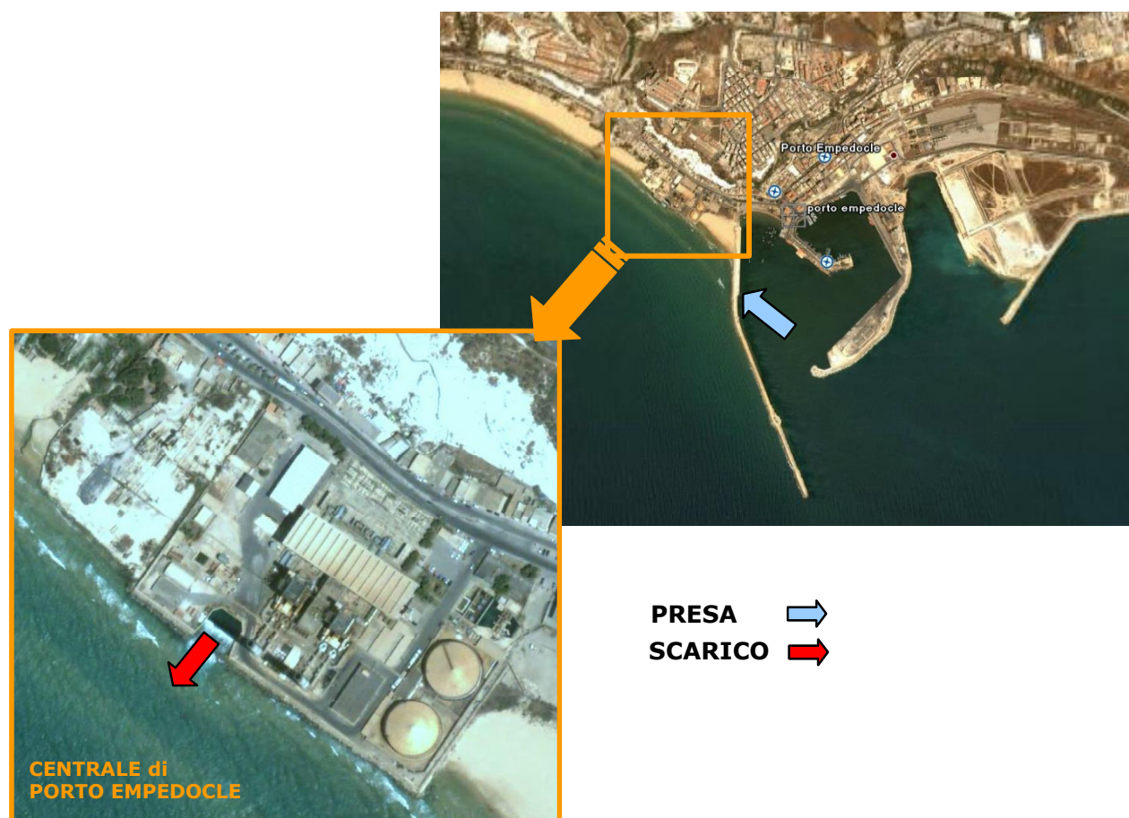
Figura 2 Collocazione delle opere di presa e di scarico della centrale di Porto Empedocle; l'opera di presa si colloca all'interno dell'adiacente area portuale di Porto Empedocle
