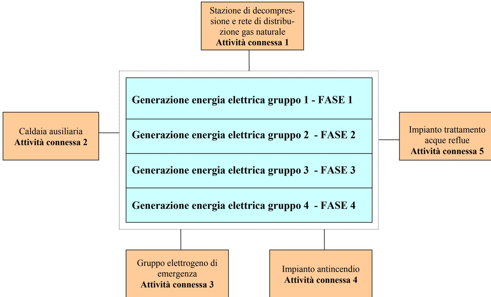
A.25 – Schema a blocchi delle fasi e delle attività tecnicamente connesse (attività ausiliarie) dell’impianto di Maddaloni
