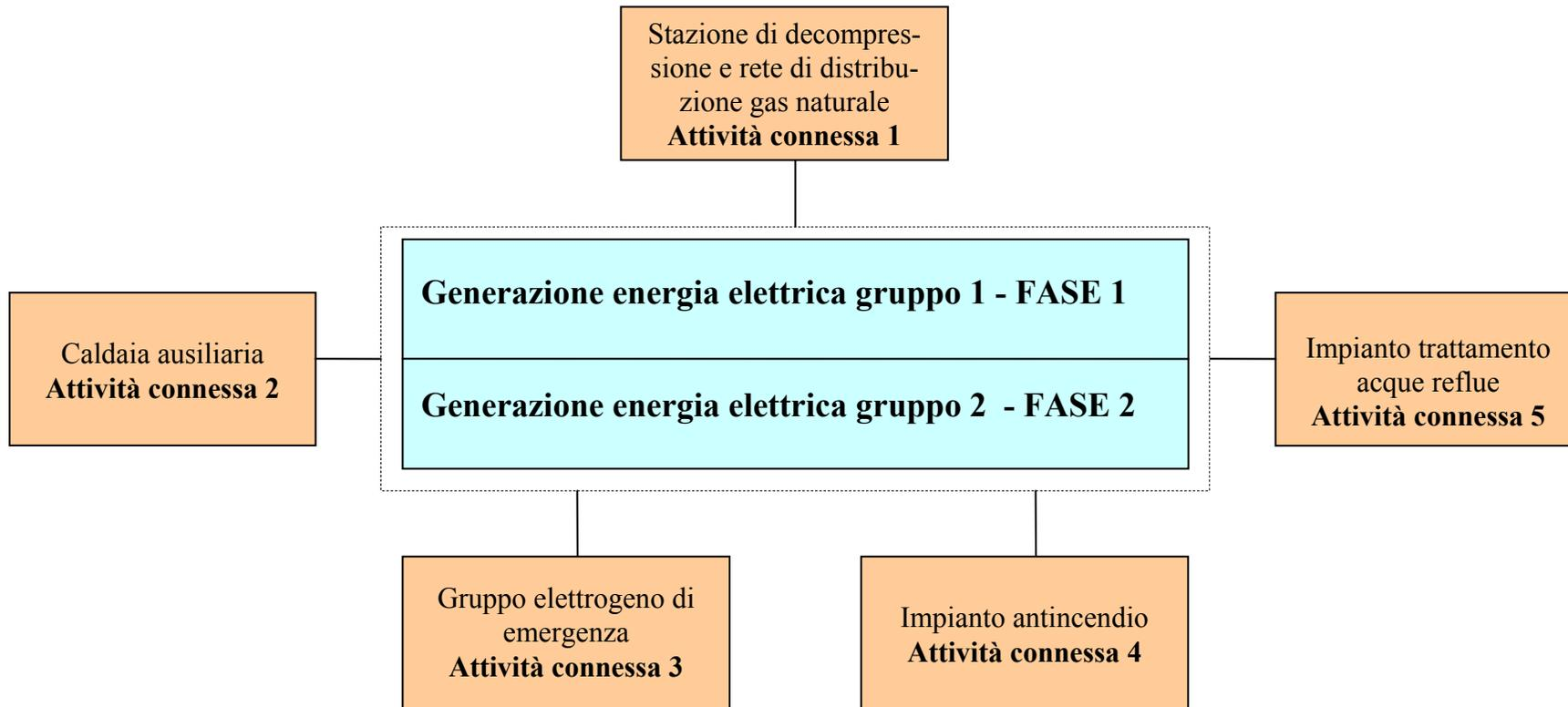
A.25 – Schema a blocchi delle fasi e delle attività tecnicamente connesse (attività ausiliarie) dell'impianto di Larino
