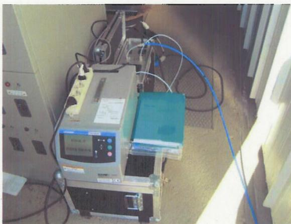
Il gas è stato prelevato dal punto di misura, posto sulla linea di scarico all'atmosfera, appositamente predisposto per questo scopo
