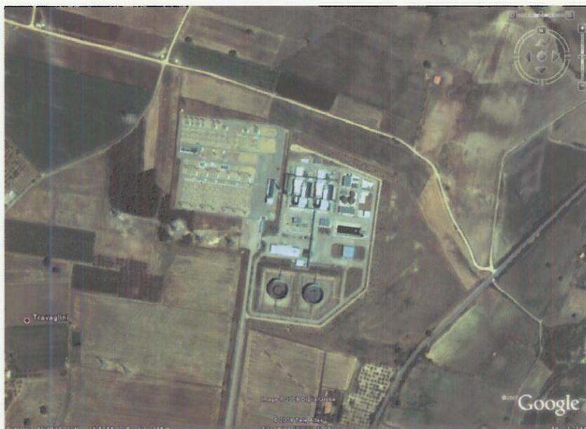
L'impianto è costituito da n. 2 gruppi turbogas di generazione turbogas della potenza di 125 MWe/ cad, alimentati a gas metano, ed è stato realizzato in attuazione del piano di costruzione di impianti turbogas di emergenza, a ciclo semplice, proposto da ENEL al CIPE nel 1975.
