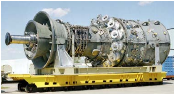
Fig.3.2.7: La turbina a gas GE 9H pronta per l'installazione nella centrale di Baglan Bay in Scozia. Si tratta della macchina più "calda" oggi in esercizio (temperatura ingresso in turbina attorno a 1450°C) che ottiene in ciclo combinato un rendimento del 60% (fonte: GE).
