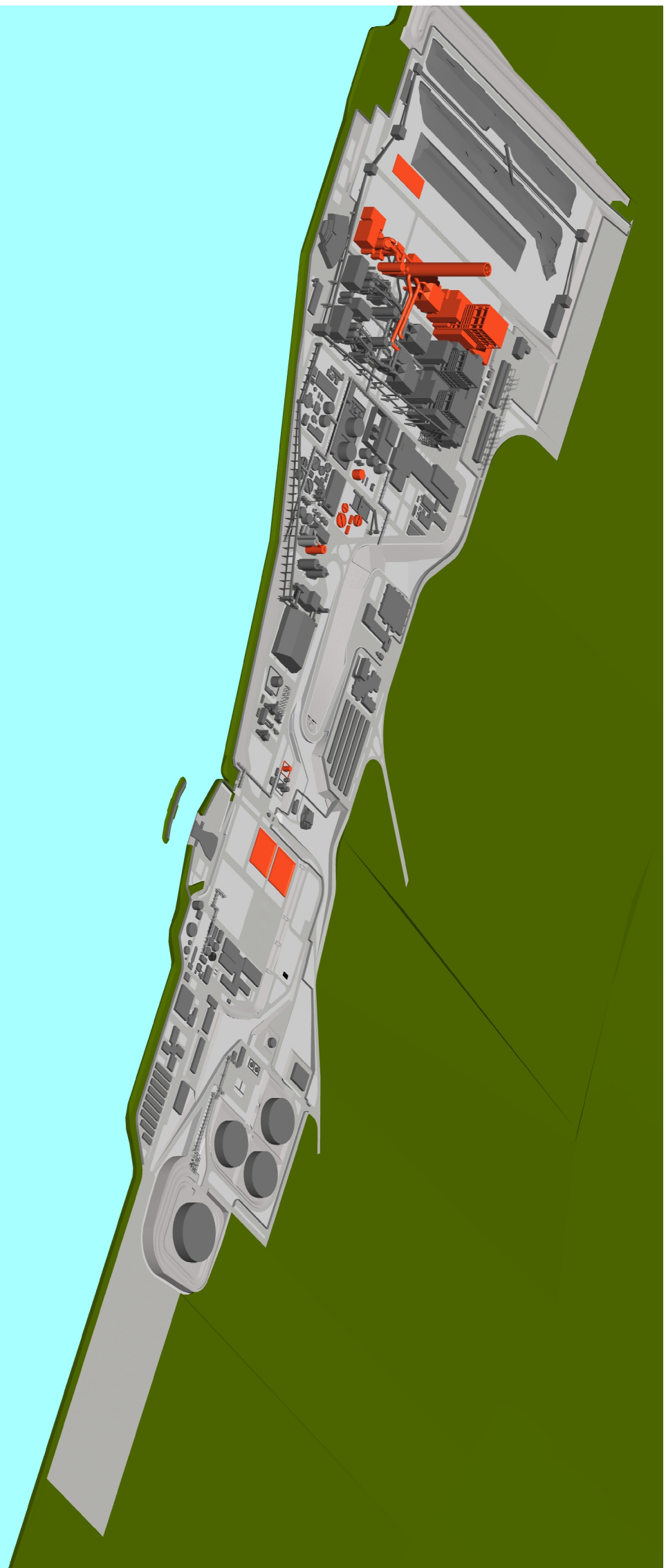
Figura C6.4 Viste Prospettiche della Centrale - Configurazione Futura (in Rosso sono Indicate le Nuove Costruzioni della Configurazione Futura)
