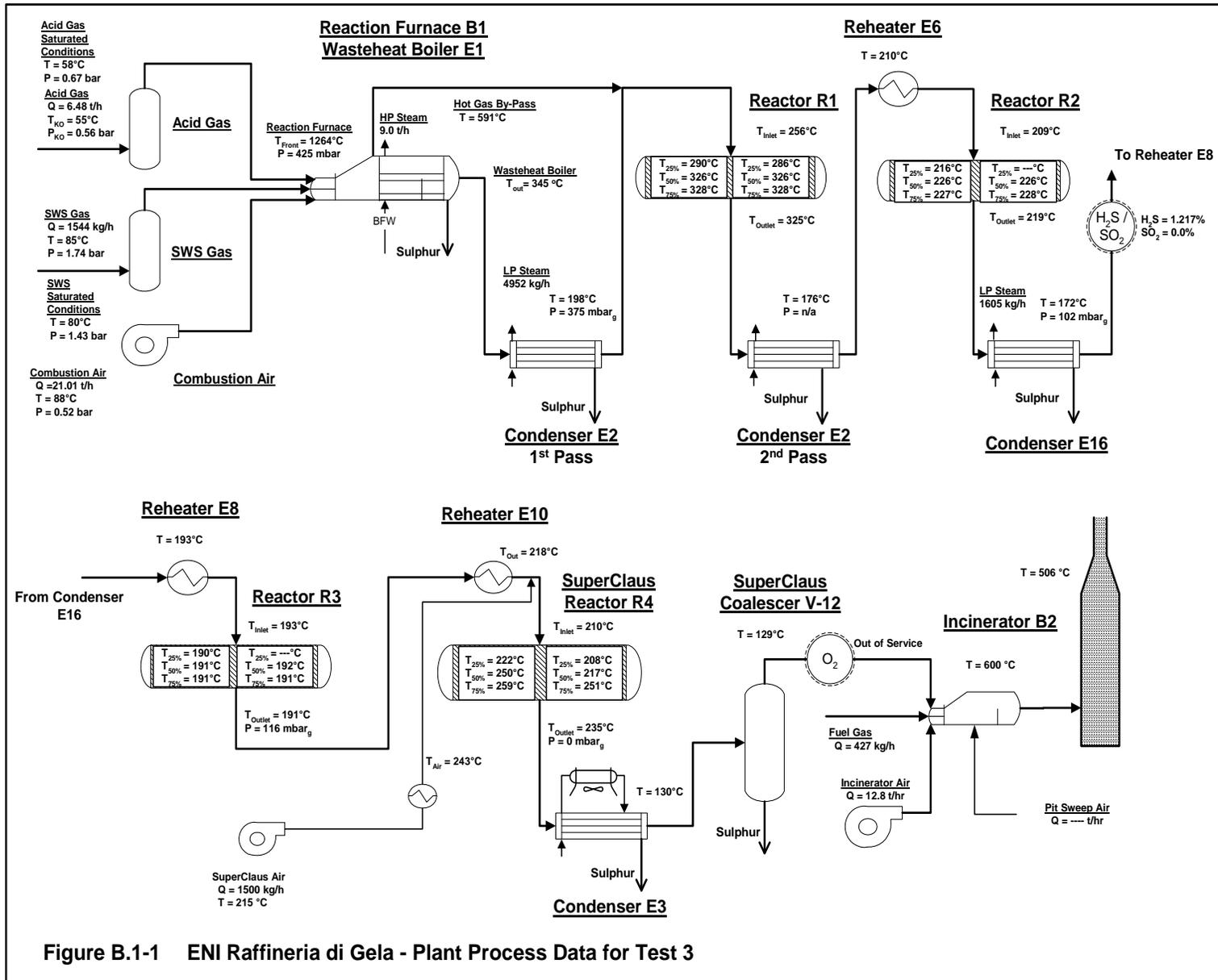
Figure B.1-1 ENI Raffineria di Gela - Plant Process Data for Test 3
