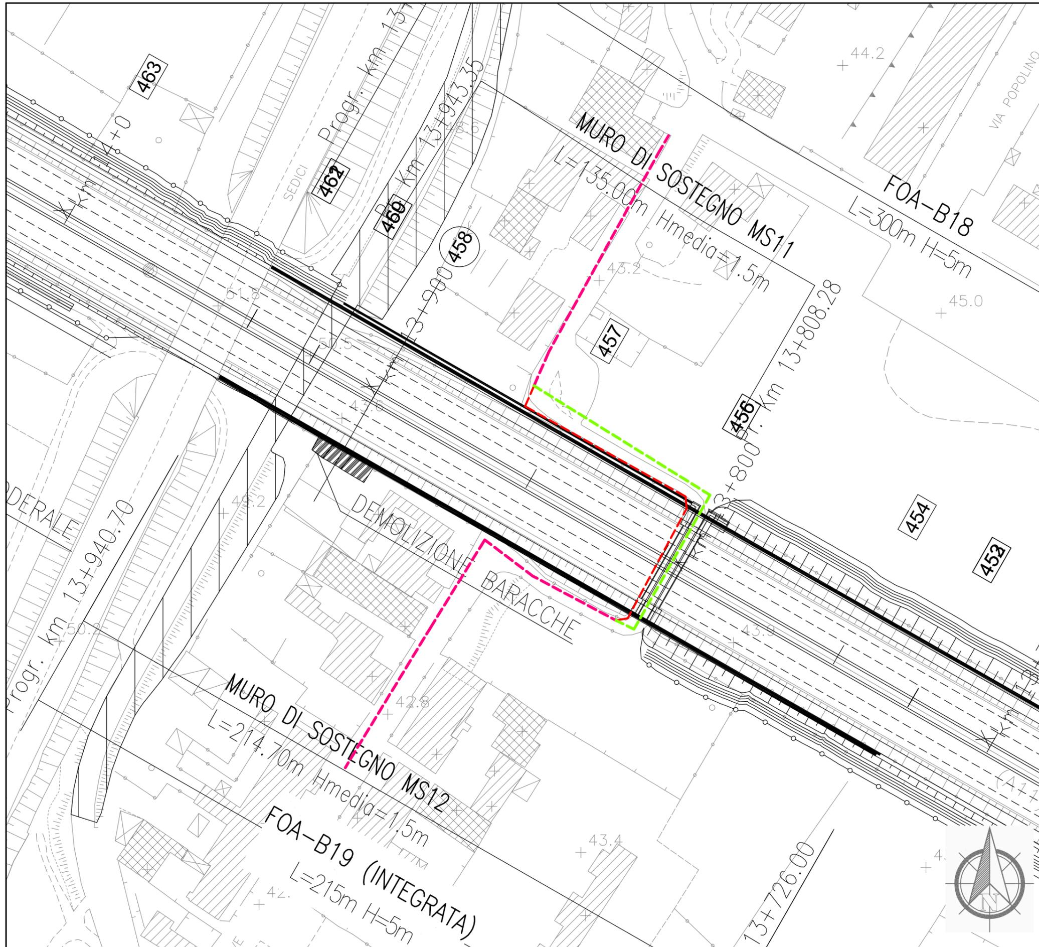
**Dettaglio interferenza e risoluzione adottata**
