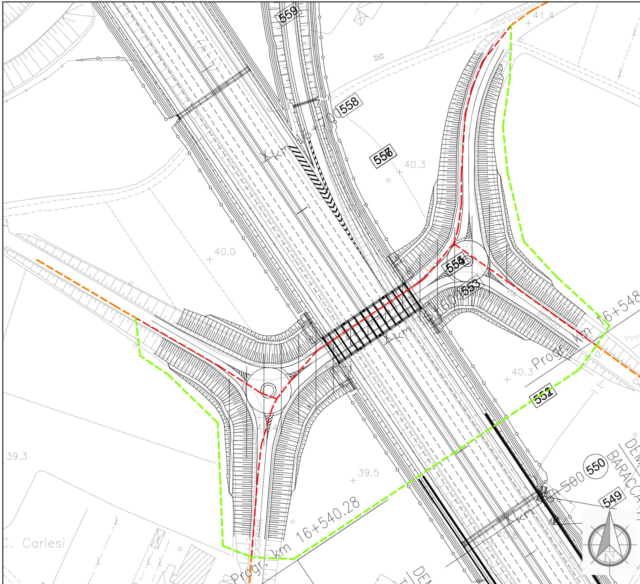
**Dettaglio interferenza e risoluzione adottata**
