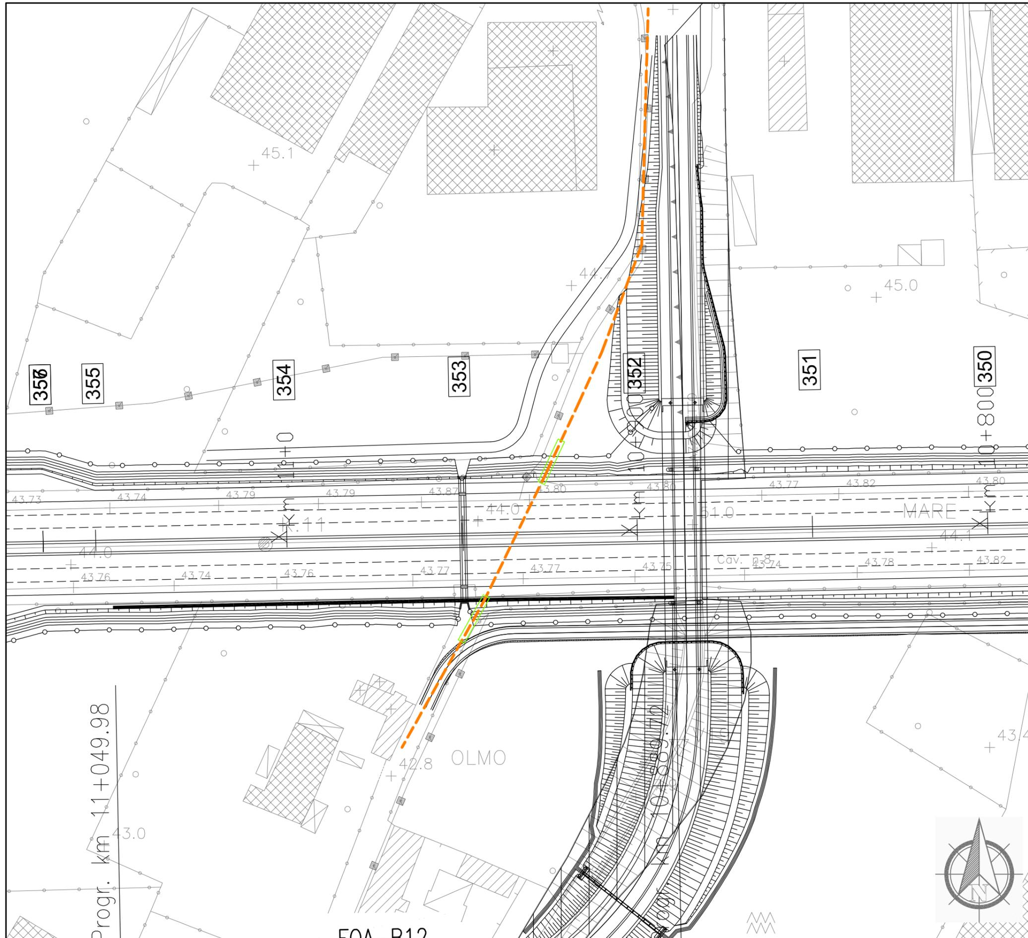
Dettaglio interferenza e risoluzione adottata
