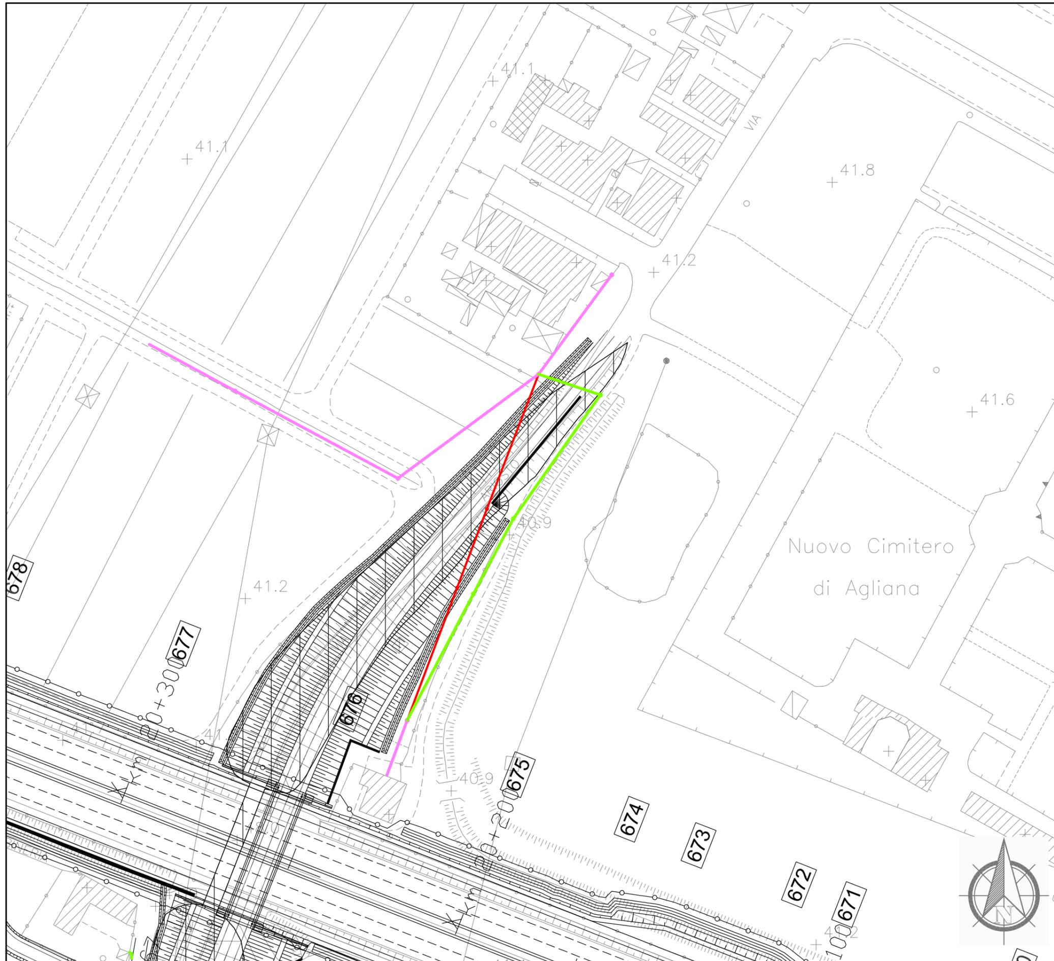
**Dettaglio interferenza e risoluzione adottata**
