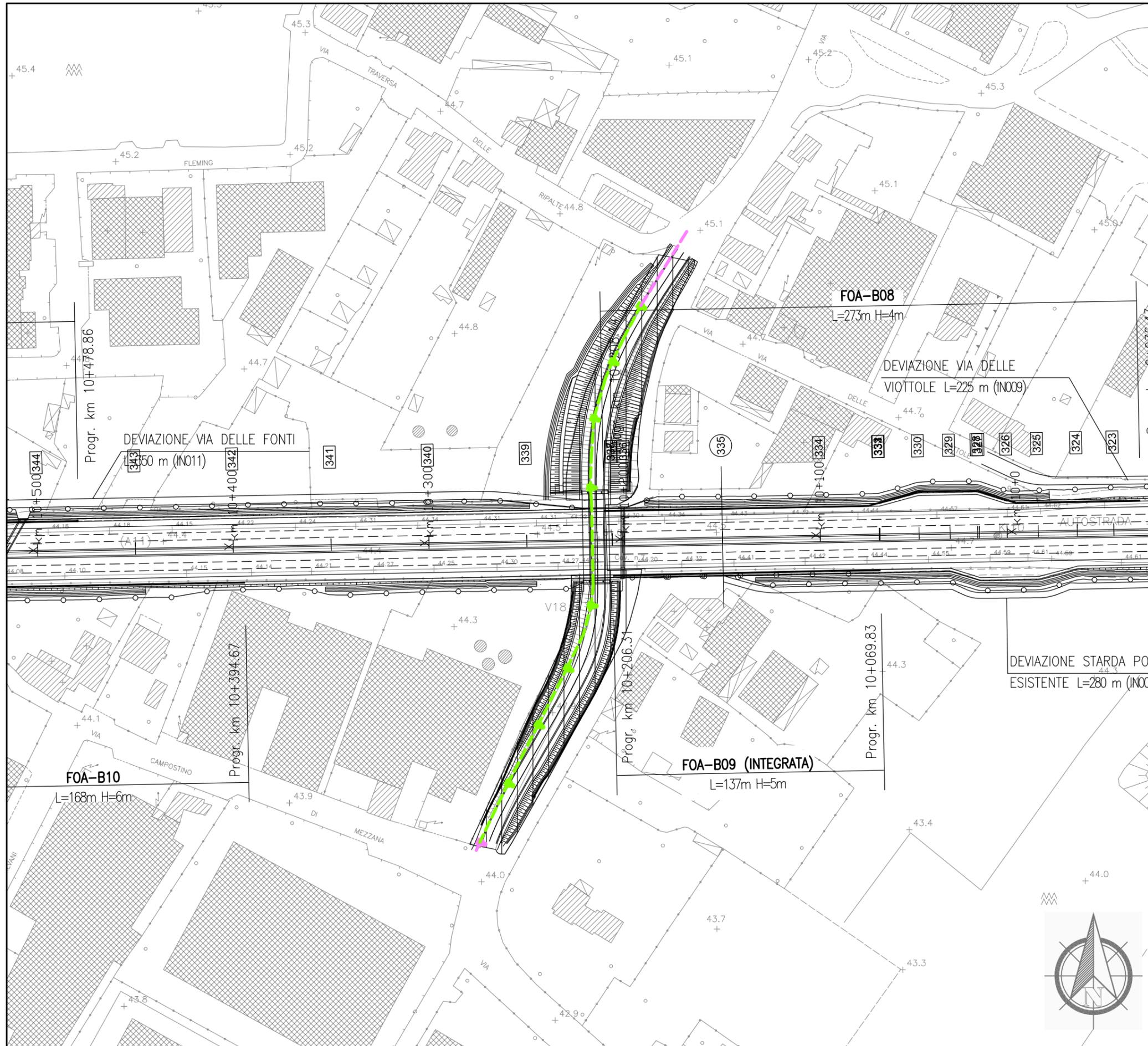
**Dettaglio interferenza e risoluzione adottata**
