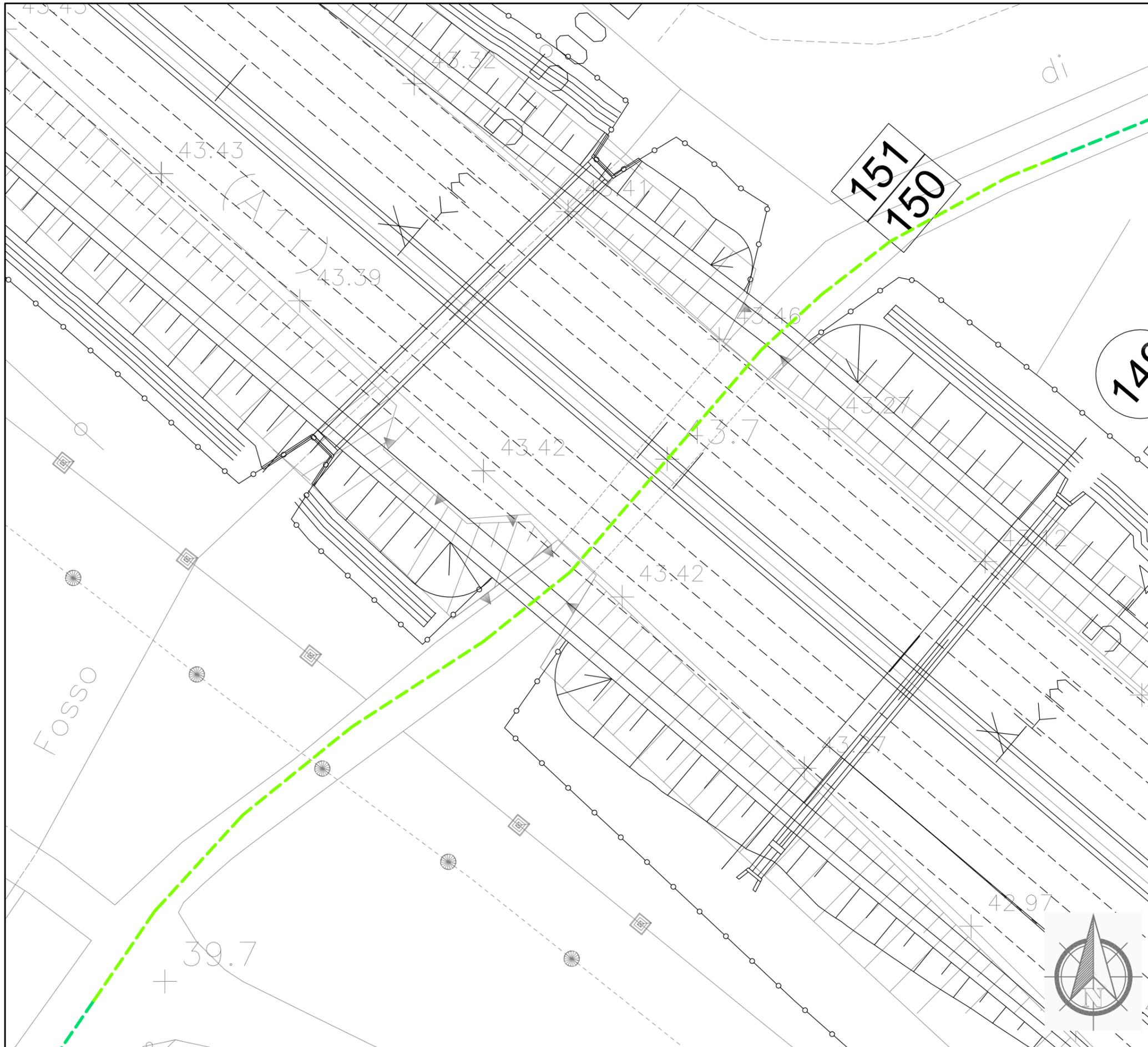
**Dettaglio interferenza e risoluzione adottata**
