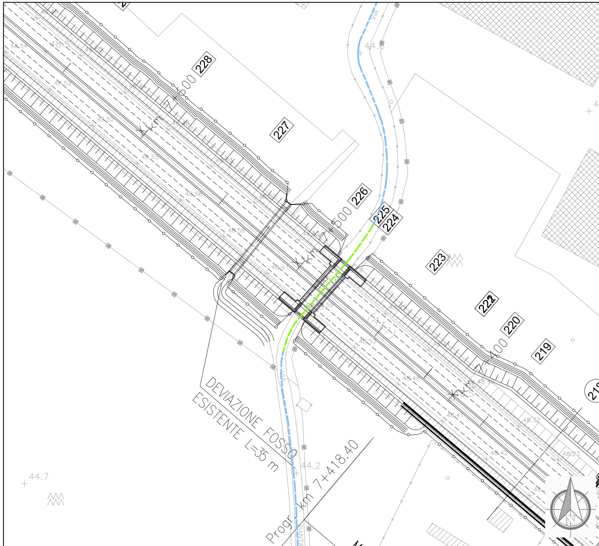
**Dettaglio interferenza e risoluzione adottata**
