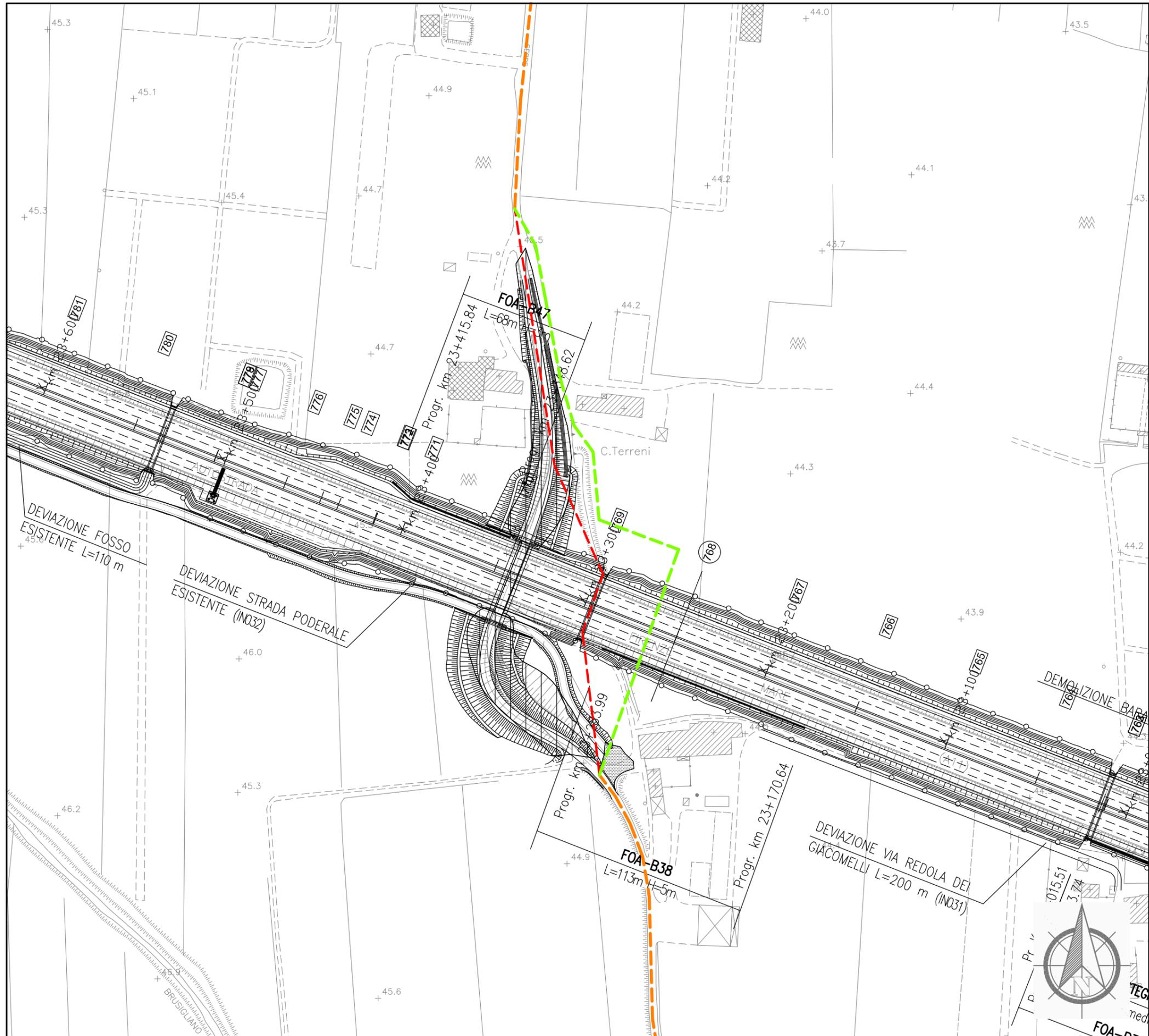
Dettaglio interferenza e risoluzione adottata
