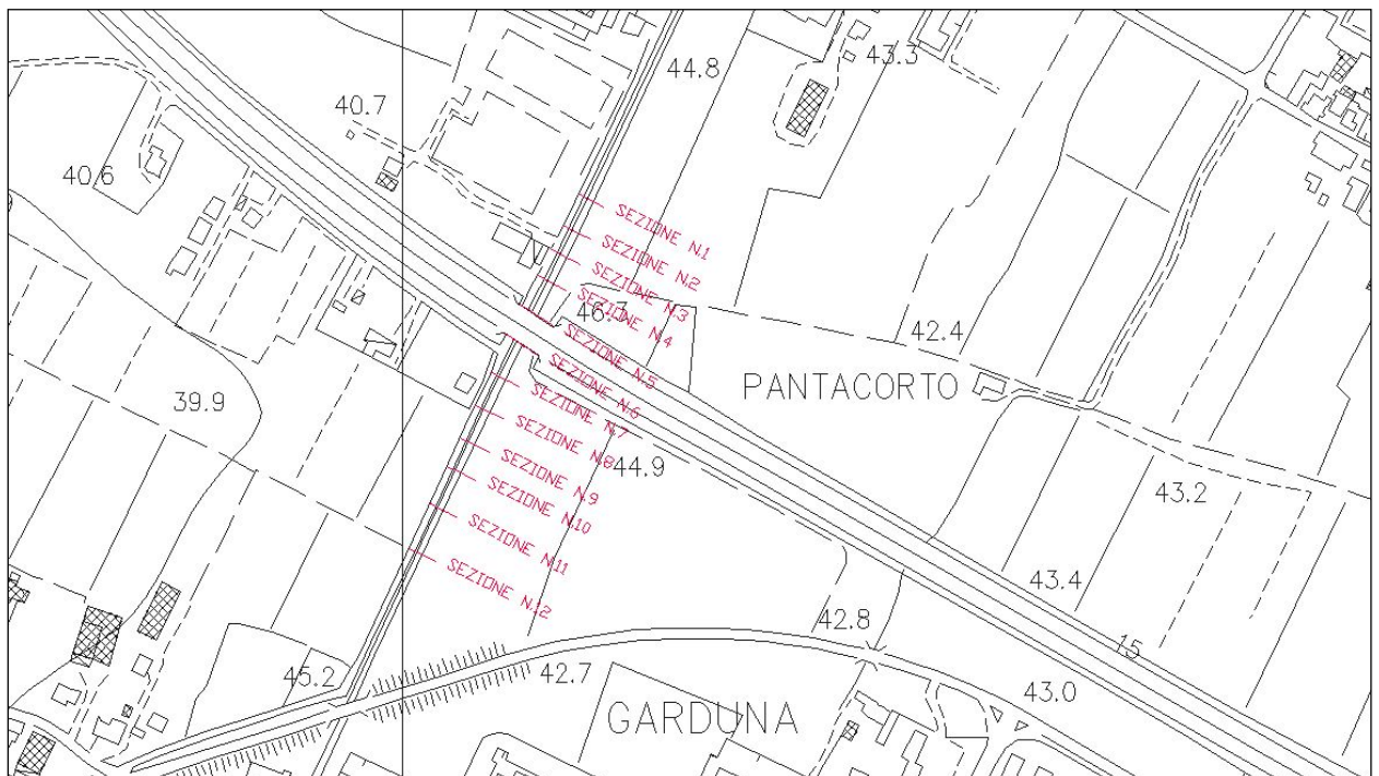
Figura 18 - Stralcio cartografico del tratto di corso d'acqua simulato con la rappresentazione planimetrica delle sezioni di rilievo utilizzate nel modello di simulazione.
