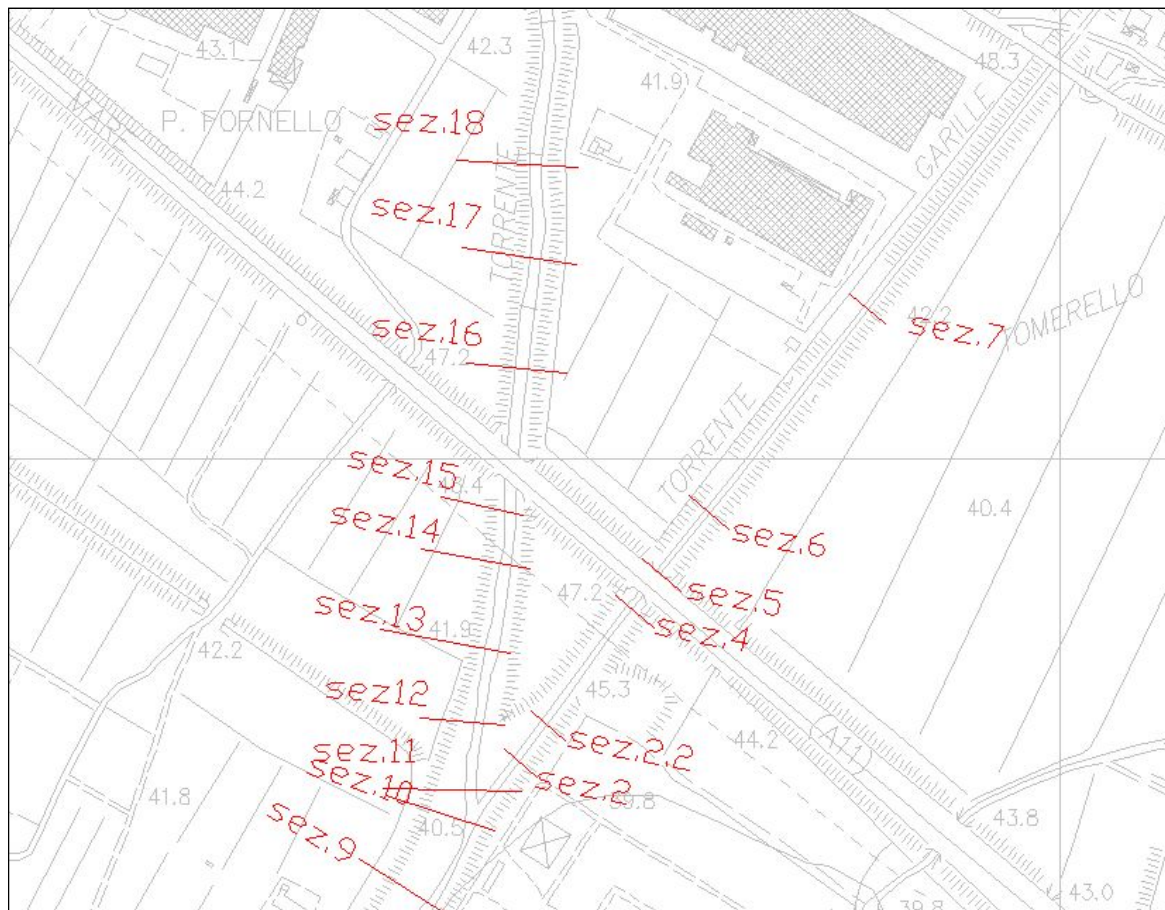
Figura 6 - Stralcio cartografico del tratto di corso d'acqua simulato con la rappresentazione planimetrica delle sezioni di rilievo utilizzate nel modello di simulazione.
