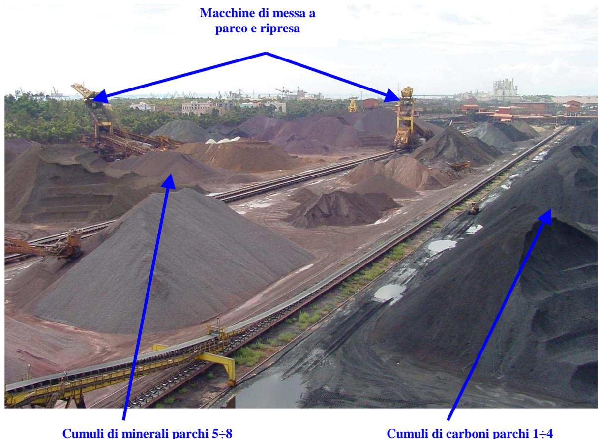
Per la prevenzione e limitazione delle eventuali emissioni a carattere diffuso da tali parchi di stoccaggio nonché per evitare la diffusione delle polveri all'esterno dovuta a particolari condizioni meteo, si adottano sistemi di protezione attiva e sistemi di protezione passiva.
