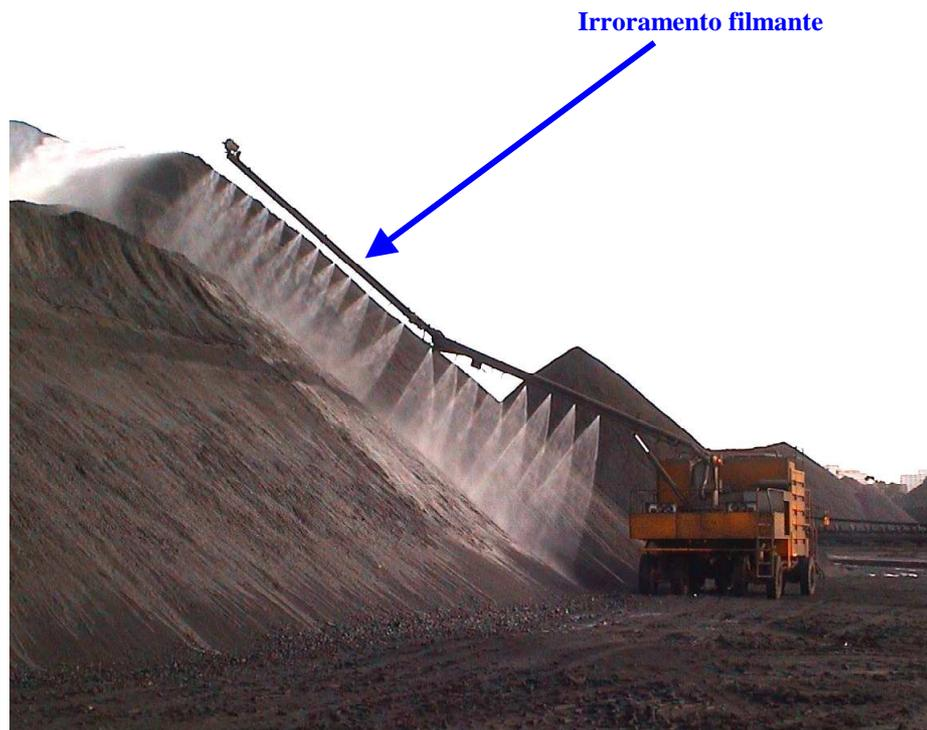
In particolari condizioni meteo climatiche, o nei casi in cui se ne presenta la necessità, le azioni per la limitazione dello spolveramento sono potenziate tramite l’effettuazione di umidificazioni aggiuntive con sistemi fissi e/o mobili.
