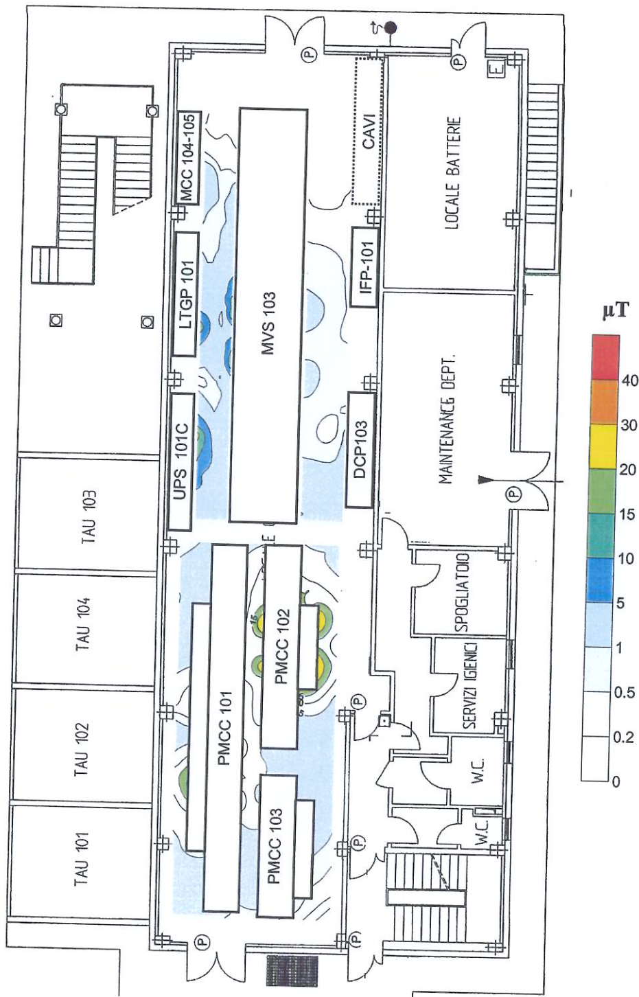
Figura 1 Mappa isolivello della Cabina elettrica principale
