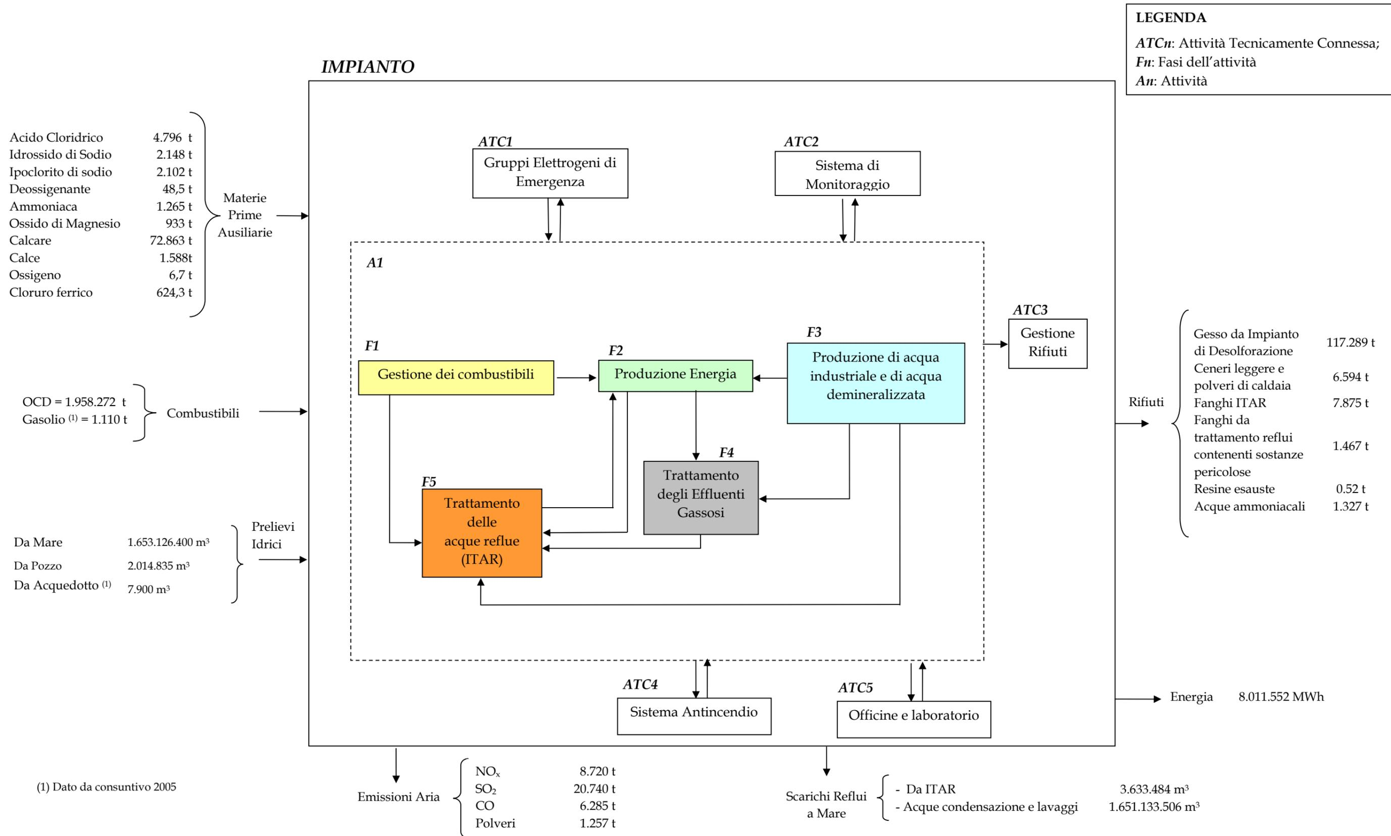
ALLEGATO A. 25 SCHEMA A BLOCCHI DELL' ATTIVITÀ PRODUTTIVA (2 DI 4)- SCHEMA DELLA FASE 2 (PRODUZIONE ENERGIA)
