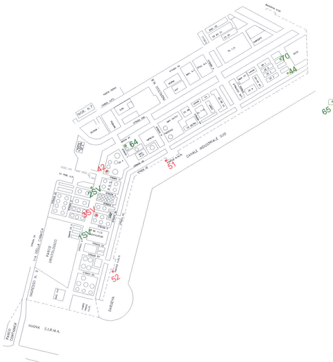
TAVOLA N°1: In rosso sono segnalate le cabine elettriche interessate dalla presenza di guarnizioni contenenti amianto; nessun riferimento può essere fatto in merito alla presenza/assenza di interruttori contenenti amianto.
