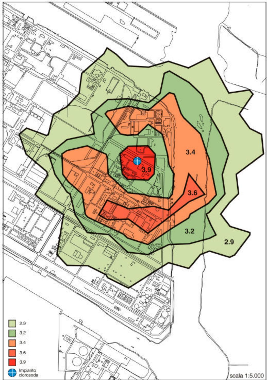
Fig. 2.4/B: Concentrazioni massime teoriche (medie su 30 minuti) di ipocloritocloro ( $\text{mg}/\text{m}^3$ ) calcolate per il nuovo impianto clorosoda
