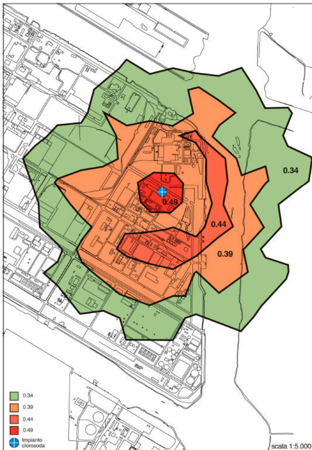
Fig. 2.4/H: Concentrazioni massime teoriche (medie su 30 minuti) di ipoclorito si sodio ( $\text{mg}/\text{m}^3$ ) calcolate per l'impianto clorosoda esistente con i dati di emissione misurati nel dicembre 2000
