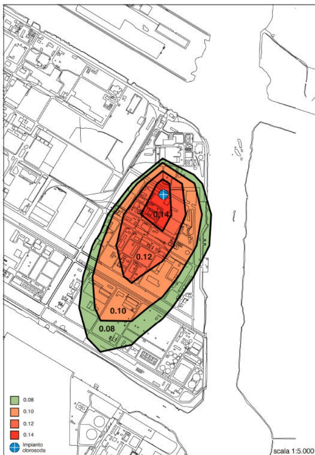
Fig. 2.4/D: Concentrazioni massime teoriche (medie annuali) di ipocloritocloro ( $\text{mg}/\text{m}^3$ ) calcolate per il nuovo impianto clorosoda
