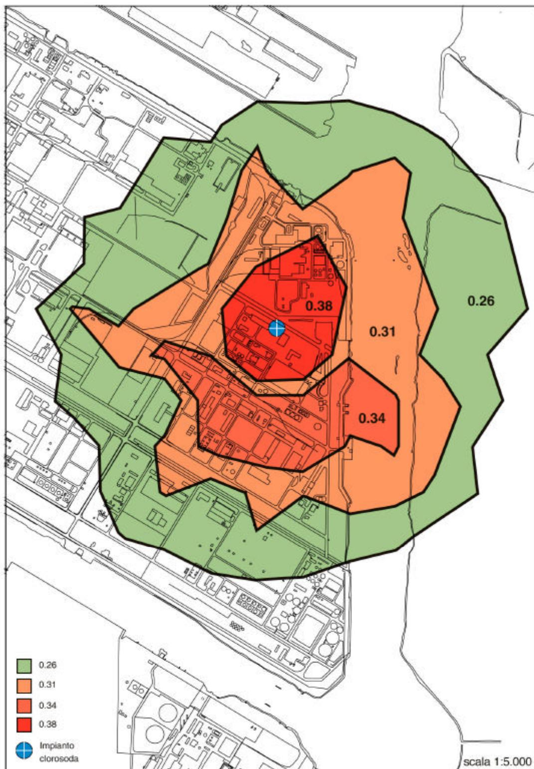
Fig. 2.4/F: Concentrazioni massime teoriche (medie su 30 minuti) di ipoclorito di sodio ( $\text{mg}/\text{m}^3$ ) calcolate per l'impianto clorosoda esistente con i dati di emissione misurati nel giugno 2000
