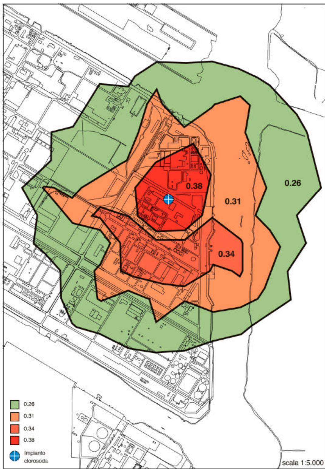
Fig. 2.4/G: Concentrazioni massime teoriche (medie su 30 minuti) di cloro ( $\text{mg}/\text{m}^3$ ) calcolate per l'impianto clorosoda esistente con i dati di emissione misurati nel dicembre 2000
