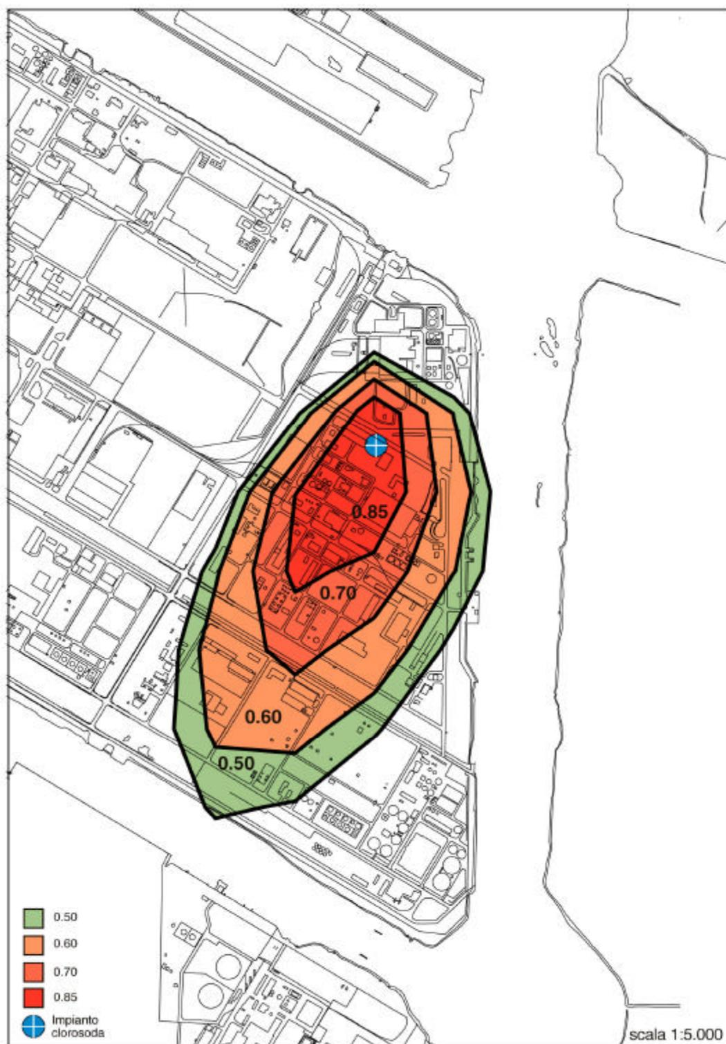
Fig. 2.4/E: Concentrazioni massime teoriche (medie su 30 minuti) di cloro ( $\text{mg}/\text{m}^3$ ) calcolate per l'impianto clorosoda esistente con i dati di emissione misurati nel giugno 2000
